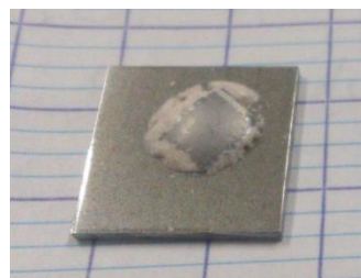
Figure II.2.3: Dépôt sur une goutte à la composition eutectique Al_2O_3 -YAG-ZrO 2 :Y avec un substrat en molybdène.
