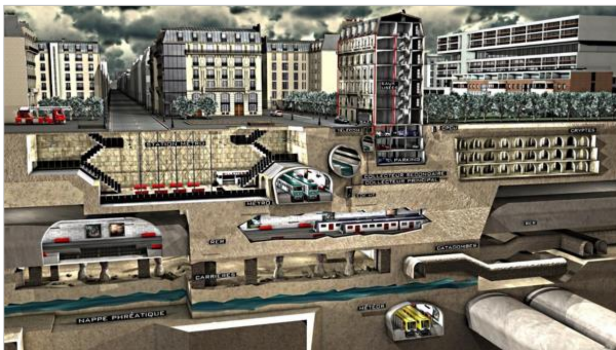
Figure 17. Schéma descriptif du Sous-sol parisien (source RATP).
