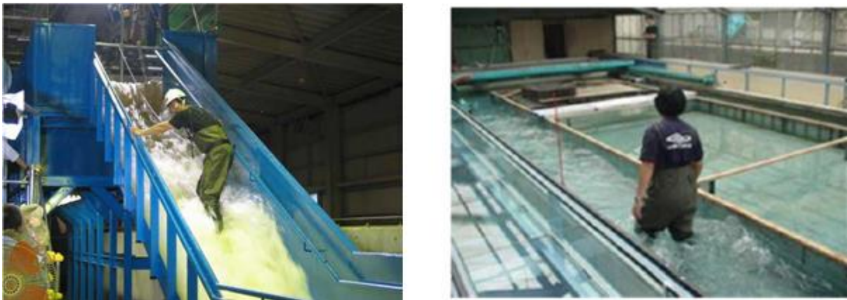
Figure 65. Etude de capacité de déplacement d'une personne dans un escalier et dans un couloir.
