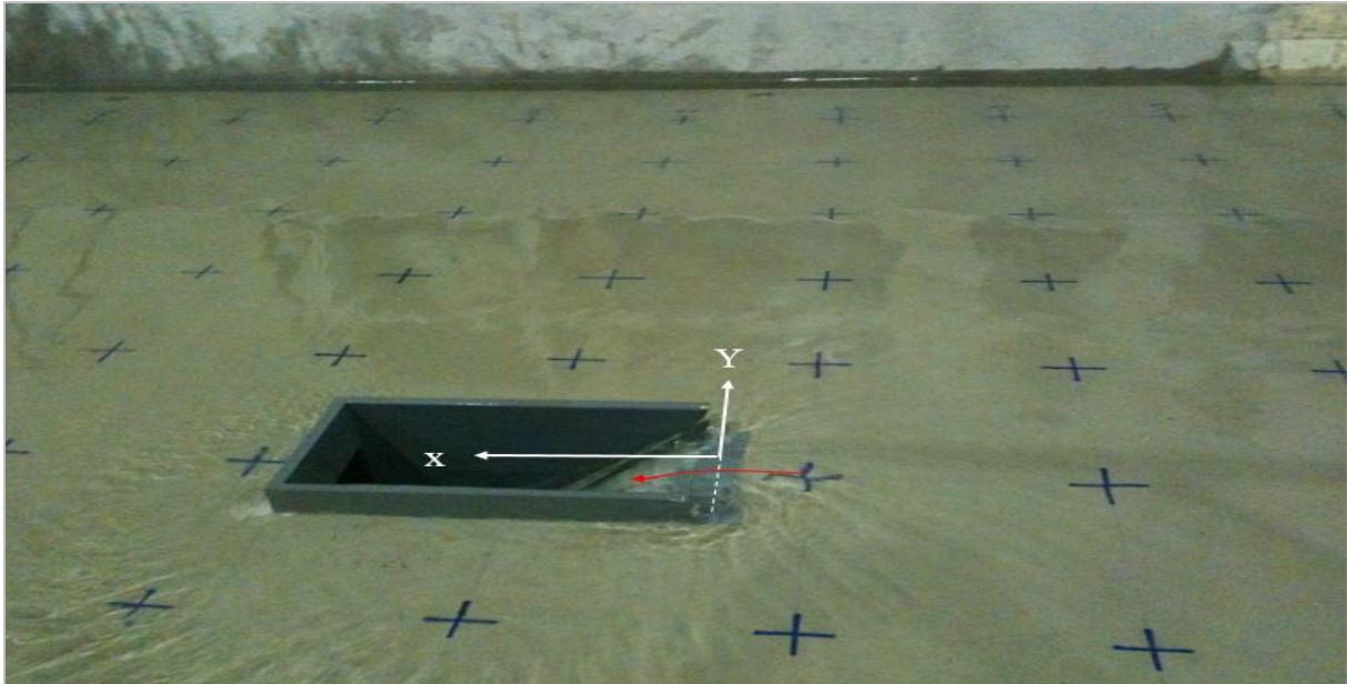
Figure 21. Ecoulement courbé sur le seuil d'accès à la bouche de métro. Configuration SB
