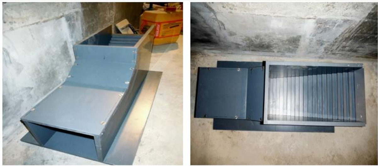
Figure 17. Bouche de métro construite dans notre essai.
