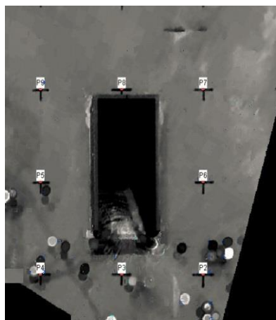
Figure 2. C.II. Exemple d'orthorectification d'une image d'un modèle de bouche de métro.
