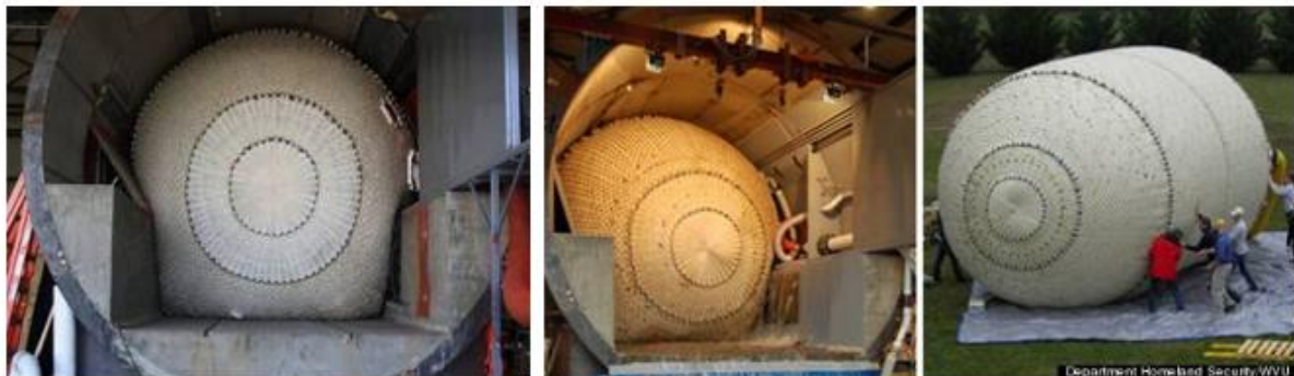
Figure III.E.9. Protection par obturateur gonflable.
