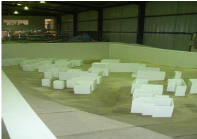
Figure 3. Modèle physique de Smith avec bâtiments installés (Smith et al, 2012)
