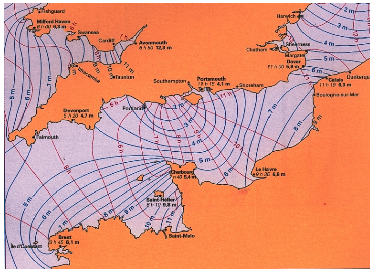
FIGURE III.2 – Évolution de la marée réelle dans la manche avec en bleu, les lignes d'isomarnage représentant une valeur égale de marnage, et en rouge, les lignes cotidiales représentant les points se trouvant en pleine mer à la même heure ( source Ifremer ).
