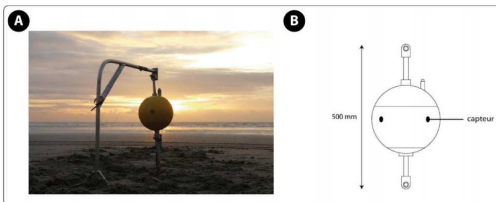
FIGURE III.16 – A) Photographie d'un S4 ADW déployé sur l'estran. B) Schéma technique d'un S4 ADW. source Adrien Cartier
