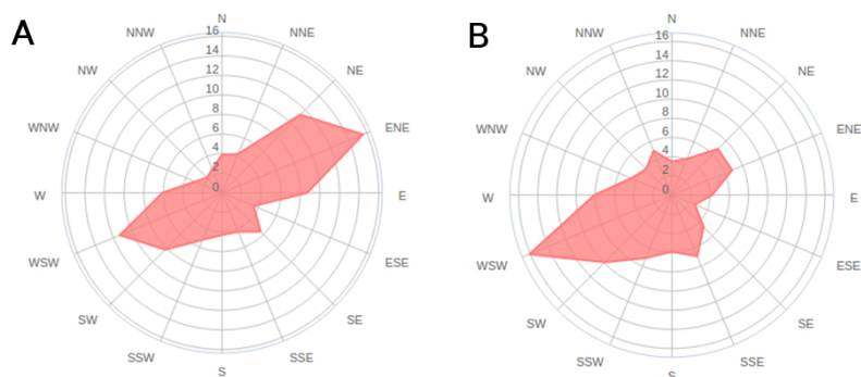
FIGURE III.26 – A) Vent moyen mensuel des mois de mars à Hardelot(entre 2003-2014), B) Vent moyen annuel à Hardelot (entre 2003-2014), © 2014 Windfinder.com GmbH & Co. KG
