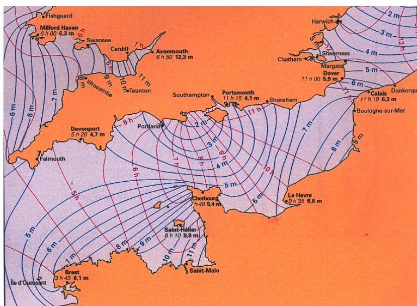
FIGURE V.1 – Évolution de la marée réelle dans la manche (source Ifremer).
