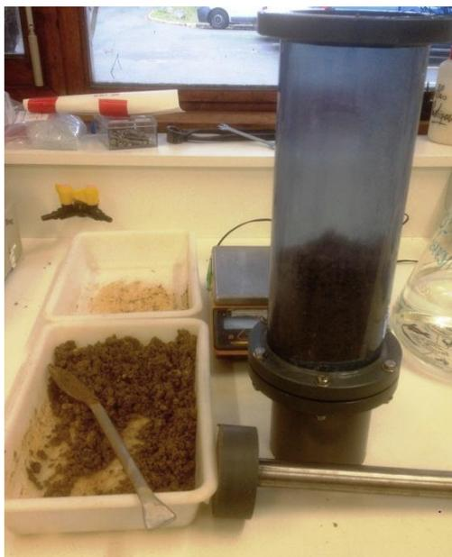
**Figure 8.3 Etape de remplissage de la colonne PVC avec le lithofaciès Gcm,b reconstitué**
