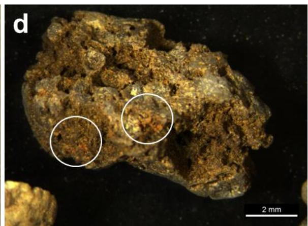
Figure D.3 Observation de tâches rougeâtres (encadrées) à la surface des grains du S-x (a), du Gcm,b [0,2]mm (b) et du Gcm,b ]2,10]mm (c et d) qui sont probablement des oxyhydroxydes de fer.
