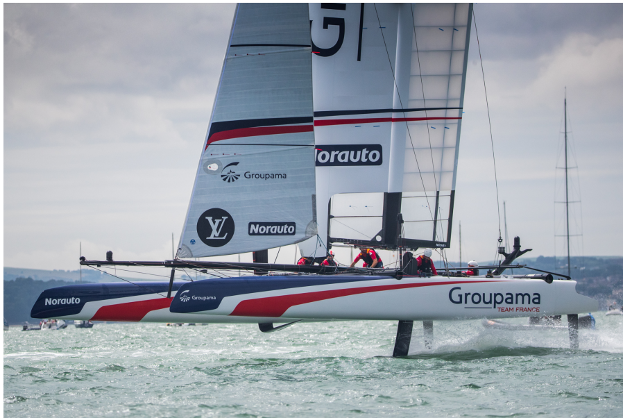
FIGURE 8.5 – Illustration de l'utilisation du foil AC45 sur le bateau de course de Groupama Team France, Credit : © Eloi Stichelbaut / Groupama Team France
