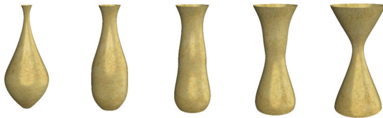
FIGURE 2.1 – Illustration d'un processus de morphing appliqué sur une surface B-Spline, issue de l'article [Ju and Goldman, 2003]
