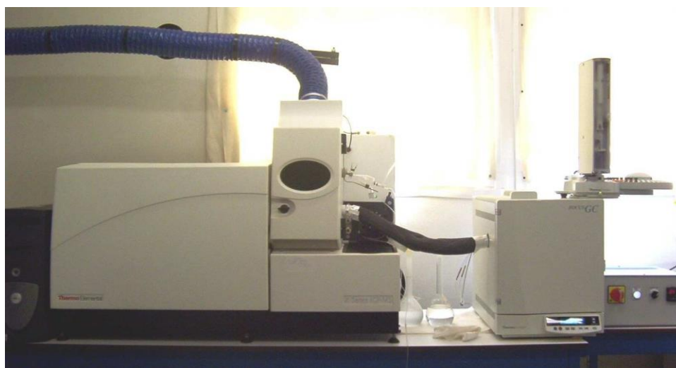
Figura 19 : GC acoplado al ICPMS en el LCABIE ( Thermo Focus-Thermo X-series ), Pau, Francia.
