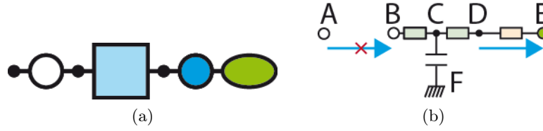
FIGURE 5.8 – Un élément conducteur est envahi de gaz à gauche. La valve correspondance est donc « gaz ». (a) Représentation schématique de l'état du réseau (b) Représentation électrique.
