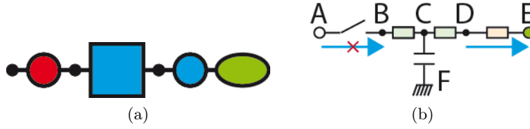
FIGURE 5.7 – Un élément conducteur est connecté à un élément conducteur rempli de gaz à gauche. La valve correspondance est donc « bloquée ». (a) Représentation schématique de l'état du réseau (b) Représentation électrique.
