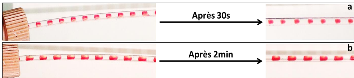
Figure 45 : Temps de diffusion lorsque deux solutions sont mélangées dans des gouttes en circulation au sein d'un capillaire de diamètre interne de 1mm. (a) 30 secondes pour des gouttes avec 1 \leq L/W \leq 2 (b) deux minutes pour des plugs avec L/W > 2 (Zhang, 2015).
