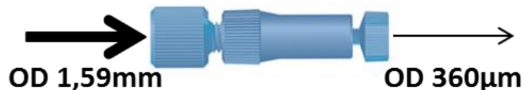
Figure 48 : Photographie de la jonction linéaire utilisée pour transférer les cristaux d'un capillaire de 150 \mu m ID et 1,59mm OD vers un capillaire de 150 \mu m ID et 360 \mu m OD.
