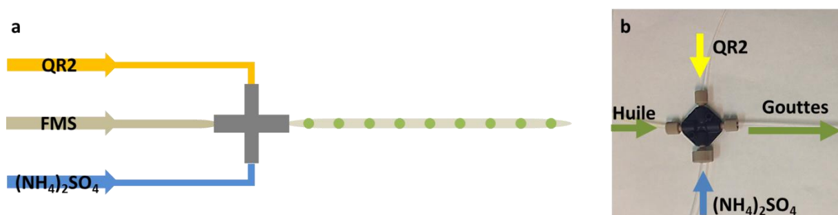
Figure 69 : (a) Schéma et (b) photographie de la formation des gouttes dans une jonction en croix.
