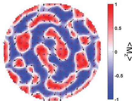
**Figure III.10** – Simulation micromagnétique à 0 K de la composante de l’aimantation selon  $\mathbf{e}_z$  d’un plot de CoFeB adjacent à une ligne de tantale dans laquelle est injectée une impulsion de courant. Ce résultat correspond à l’état d’aimantation  $M_z$  à 1,37 ns du graphique III.9.
