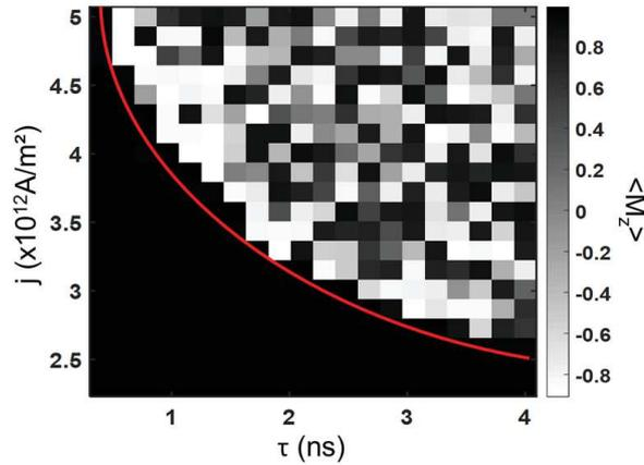
**Figure III.8** – Simulation micromagnétique à 0 K de la densité de courant de retournement d'une aimantation  $\uparrow$  (noir) à  $\downarrow$  (blanc) en fonction de la durée de l'impulsion. La ligne rouge est un guide pour définir une densité de courant critique à partir de laquelle le processus de retournement de l'aimantation commence.
