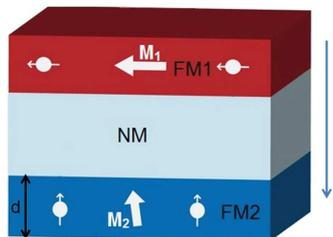
**Figure I.17** – Schéma d'une tricouche magnétique traversée par un courant  $I$  avec FM1 (FM2) le matériau ferromagnétique 1 (2) et NM le matériau non-magnétique. Les aimantations  $M_1$  et  $M_2$  sont représentées par des flèches blanches et les électrons et leur spin par des disques blancs surmontés d'une flèche.
