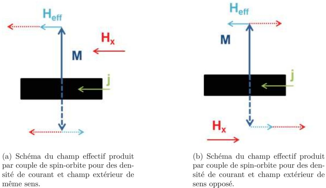
**Figure III.4** – Vision schématique du retournement de l'aimantation par couples de spin-orbite sous l'action du couple de type Slonczewski (représenté par le champ magnétique qui lui est associé  $\mathbf{H}_{eff}$ ) et d'un champ extérieur  $\mathbf{H}_{planaire}$  appliqué colinéairement au courant de droite à gauche (a) et de gauche à droite (b).
