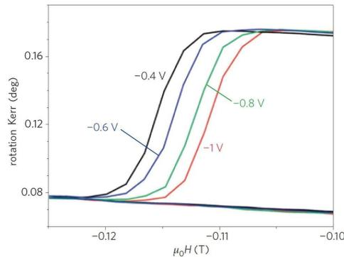
**Figure I.33** – Retournement de l'aimantation d'une couche de FePt de 2 nm d'épaisseur pour différentes valeurs de tension appliquée entre l'électrolyte (via la contre-électrode de Pt) et la couche mince de FePt ou FePd [110].
