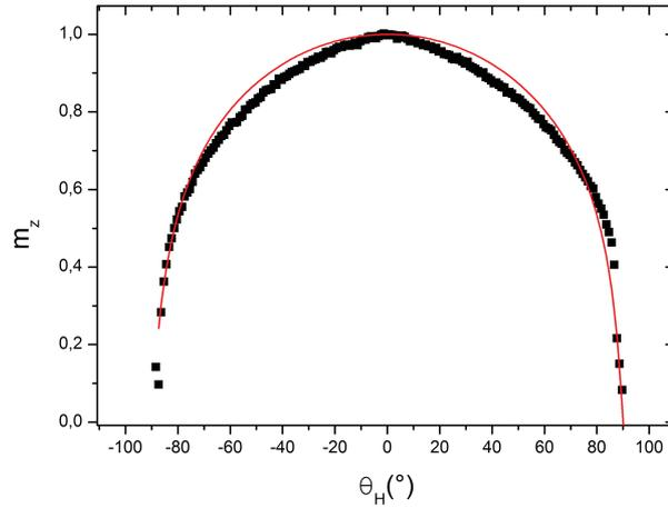
**Figure IV.4** – Courbes de résistance de Hall normalisée en fonction de l’angle  $\theta_H$  entre la direction d’anisotropie magnétique facile, perpendiculaire au plan des couches minces, et la direction du champ magnétique appliqué. Les carrés noirs sont les points expérimentaux et la ligne rouge représente la résistance normalisée calculée. Cette figure correspond à un zoom de la courbe IV.3 autour du maximum de la résistance normalisée. Le champ magnétique constant est de +1955 Oe.
