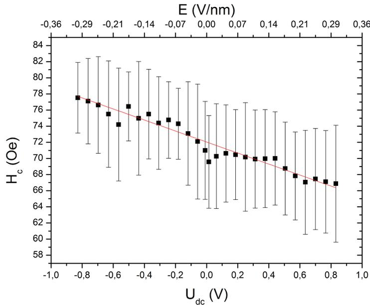
**Figure IV.8** – Variations du champ coercitif en fonction de la tension  $U_{dc}$  et du champ électrique  $E$  pour un échantillon de  $8 Ta/1,05 Co_8Fe_{72}B_{20}/MgO/5 Ta/5 Ru$ . Les barres d'erreur correspondent à l'écart-type pour 20 cycles d'hystérésis effectués pour chaque valeur de champ électrique et la droite rouge correspond à un ajustement linéaire.
