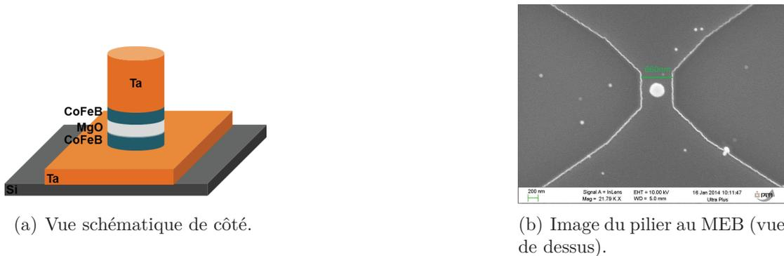
**Figure II.4** – Piste de tantale et piler magnétique lithographiés après le second niveau.
