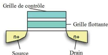
**Figure I.4** – Schéma d'un transistor à grille flottante, cellule mémoire de la Flash.
