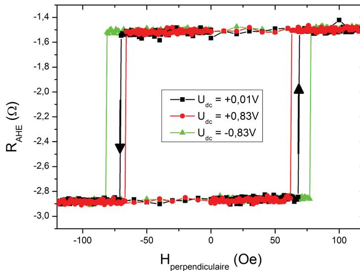
**Figure IV.7** – Mesures de la résistance d'effet Hall anomal en fonction du champ magnétique appliqué perpendiculairement au plan des couches minces en présence d'une tension  $U_{\text{dc}}$  appliquée aux bornes de l'échantillon. Les différentes couleurs codent pour les différentes valeurs de tension  $U_{\text{dc}}$  et les flèches indiquent le sens dans lequel est parcouru le cycle en partant de  $H_{\text{perpendiculaire}} = 0$ .
