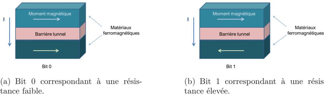
**Figure I.5** – Schéma d’une jonction tunnel magnétique et effet de magnétorésistance tunnel. Le courant  $I$  permet de lire la valeur de la résistance, haute ou basse et de lui attribuer une valeur de bit, 0 ou 1.
