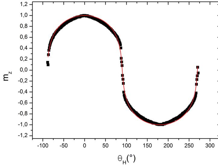
**Figure IV.3** – Courbes de résistance de Hall normalisée en fonction de l'angle  $\theta_H$  entre la direction d'anisotropie magnétique facile, perpendiculaire au plan des couches minces, et la direction du champ magnétique appliqué. Les carrés noirs sont les points expérimentaux, et la ligne rouge représente la résistance normalisée calculée. Le champ magnétique constant est de  $+1955 \text{ Oe}$ .
