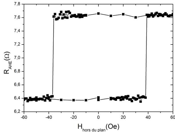
**Figure II.13** – Cycle d’hystérésis du CoFeB de l’empilement  $8\text{ Ta}/1,1\text{ Co}_{40}\text{Fe}_{40}\text{B}_{20}/\text{MgO}/5\text{ Ta}/5\text{ Ru}$  mesuré par effet Hall anomal avec une tension appliquée sur la barrière tunnel de  $0,01\text{ V}$ .
