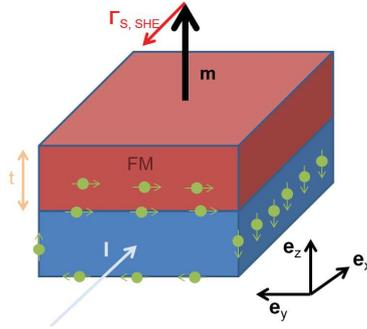
**Figure I.25** – Schéma de l'effet Hall de spin dans un métal surmonté d'un ferromagnétique : un courant de charge  $I$  traverse le métal et crée des accumulations de spins (ronds surmontés d'une flèche verte) aux interfaces. Les électrons pénètrent ensuite dans le métal ferromagnétique d'aimantation  $\mathbf{M}$ . Le couple de type Slonczewski  $\mathbf{\Gamma}_{\text{SHE,S}}$  (flèche rouge) induit par l'effet Hall de spin peut permettre de renverser l'aimantation.
