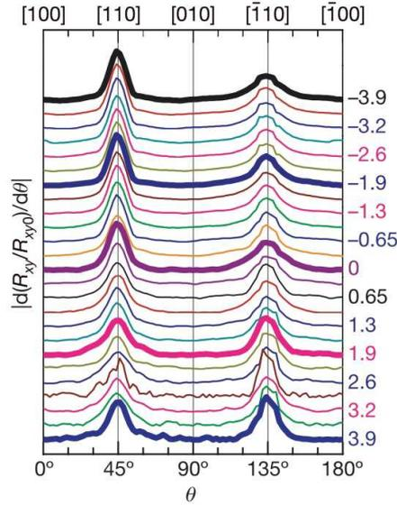
**Figure I.31** – Valeur absolue de la dérivée par rapport à l’angle  $\theta$  de la résistance d’effet Hall planaire  $R_{xy}$  normalisée par  $R_{xy0}$  tracée en fonction de  $\theta$ , l’angle entre le champ magnétique extérieur appliqué et la direction cristallographique (100) [107]. Les couleurs représentent les différents champs électriques appliqués (en MV/cm). Les pics indiquent les positions des axes d’anisotropie.
