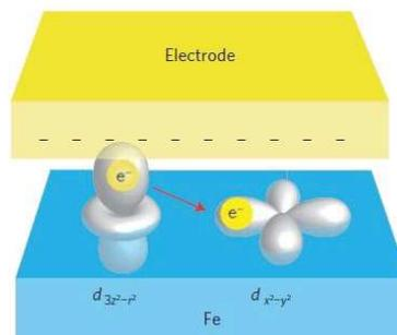
**Figure I.42** – Schéma du remplissage des orbitales atomiques dans la couche mince de fer étudiée dans la référence[117]. La flèche rouge indique un changement de remplissage dû à la tension appliquée sur le système complet : les électrons passent de l'orbitale  $3z^2-r^2$  à l'orbitale  $x^2-y^2$ .
