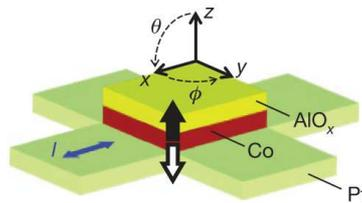
**Figure I.28** – Configuration de l'expérience de Miron et al. [91]. La flèche bleue représente la direction du courant électrique  $\mathbf{I}$ . Les flèches noire ( $\mathbf{M} > 0$ ) et blanche ( $\mathbf{M} < 0$ ) représentent les positions d'équilibre de l'aimantation : l'anisotropie est hors du plan des couches.
