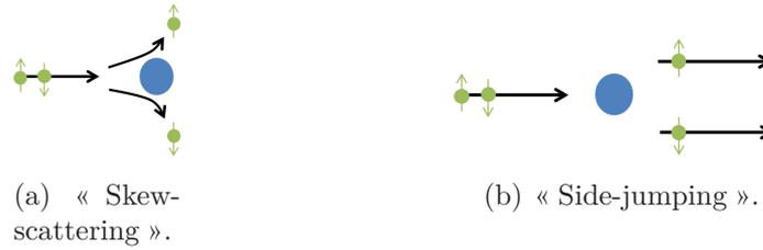
**Figure I.24** – Représentation schématique des mécanismes extrinsèques d'effet Hall de spin avec les électrons de conduction en vert surmontés d'une flèche verte (leur spin) arrivant sur une impureté (disque bleu).
