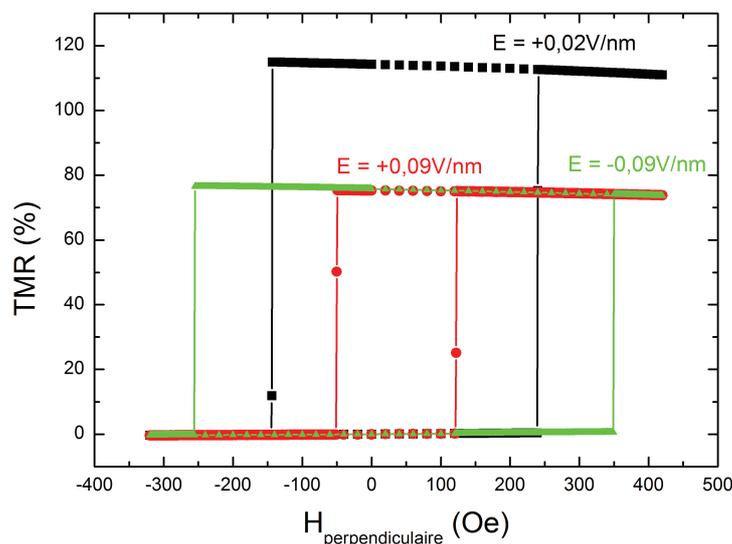
**Figure IV.9** – Cycles d'hystérésis en champ perpendiculaire d'un échantillon soumis à différents champs électriques. Les carrés noirs correspondent à un champ électrique de  $E = +0,02 \text{ V/nm}$ , les points rouges à  $E = +0,09 \text{ V/nm}$  et les triangles verts à  $E = -0,09 \text{ V/nm}$ .
