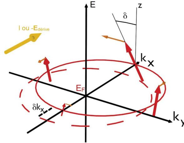
**Figure I.22** – Schéma de l'effet du couple Rashba de champ effectif  $\Gamma_{\mathbf{R},\mathbf{t}}$  sur les spins des électrons majoritaires (flèches rouges) du niveau de Fermi  $E_F$  (cercle rouge). Les flèches de couleur orange (contenues dans un plan parallèle à  $(0, \mathbf{k}_x, \mathbf{k}_y)$ ) indiquent le champ magnétique Rashba ressenti par les spins des électrons. L'intégration de tous ces champs sur la surface de Fermi donne maintenant un résultat non nul [76].
