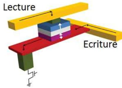
**Figure I.8** – Schéma d'une cellule SOT-MRAM [22]. En rouge la piste de métal lourd surmontée de la jonction tunnel magnétique dans laquelle le courant d'écriture passe. Les flèches noires indiquent les chemins des courants d'écriture et de lecture.
