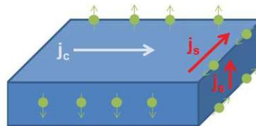
**Figure I.23** – Schéma de l'effet Hall de spin dans un métal : un courant de charge de densité  $\mathbf{j}_c$  traverse le métal et provoque des courants de spin de densités  $\mathbf{j}_s$  qui lui sont perpendiculaires. Des accumulations de spins (ronds surmontés d'une flèche verte) apparaissent sur les surfaces.
