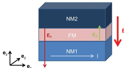
**Figure I.20** – Schéma d'une tricouche composée de deux matériaux non magnétiques différents (NM1 et NM2) entourant un matériau ferromagnétique. Dans ces structures, un champ électrique  $\mathbf{E}$  apparaît du fait de l'asymétrie structurelle qui implique des champs cristallins  $\mathbf{E}_1$  et  $\mathbf{E}_2$  différents.  $\mathbf{j}$  est la densité de courant parcourant NM1.
