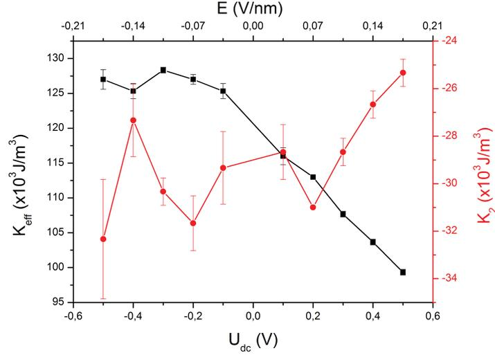
**Figure IV.6** – Variations des constantes d’anisotropie magnétique  $K_{\text{eff}}$  et  $K_2$  en fonction de la tension  $U_{\text{dc}}$  et du champ électrique  $E$ . Les barres d’erreur correspondent à l’écart-type pour les trois courbes calculées avec un décalage sur  $\theta_H$  de 0,  $+0,5^\circ$  et  $-0,5^\circ$ . Les lignes reliant les points entre eux sont un guide pour les yeux.
