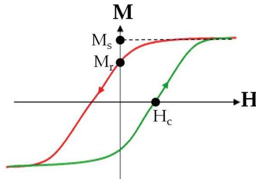
**Figure I.10** – Cycle d’hystérésis typique pour un matériau ferromagnétique : variations de l’aimantation  $\mathbf{M}$  en fonction d’un champ magnétique extérieur appliqué  $\mathbf{H}$ .  $M_s$  est l’aimantation à saturation,  $M_r$  l’aimantation rémanente et  $H_c$  le champ coercitif.
