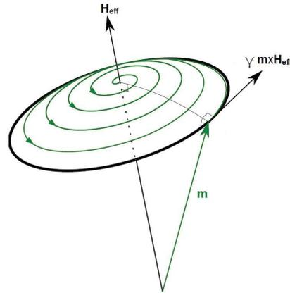
**Figure I.18** – Illustration de la précession d'un moment magnétique normalisé  $\mathbf{m}$  autour d'un champ magnétique effectif  $\mathbf{H}_{eff}$ . La trajectoire en noir correspond au terme de précession seul alors que la trajectoire en vert qui s'enroule autour de  $\mathbf{H}_{eff}$  comprend le terme d'amortissement [28].
