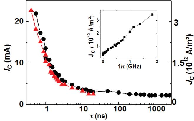
**Figure III.6** – Courant critique de retournement de l’aimantation en fonction de la durée de l’impulsion. Les points noirs (triangles rouges) ont été mesurés en présence d’un champ magnétique extérieur de 1 kOe (1,5 kOe). L’encadré présente la densité de courant critique en fonction de l’inverse de la durée de l’impulsion sous un champ magnétique de 1 kOe.
