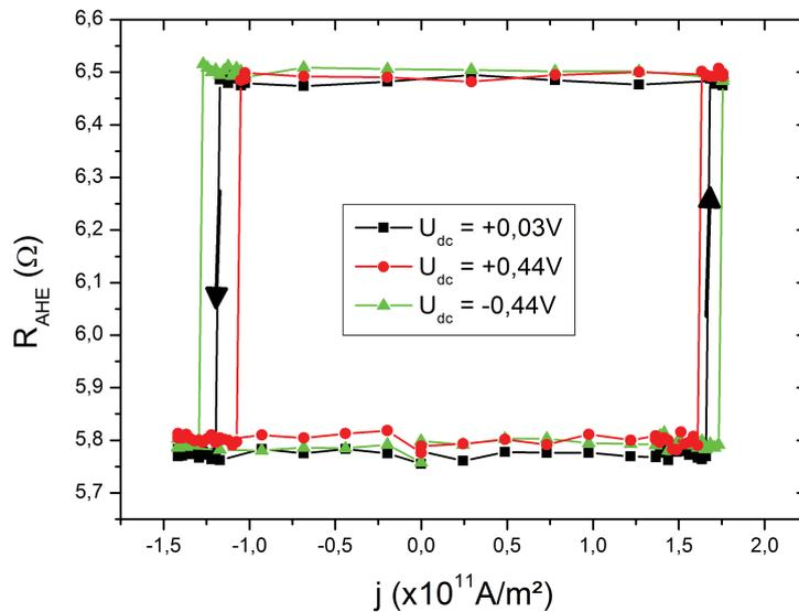
**Figure IV.11** – Résistance d’effet Hall anomal  $R_{\text{AHE}}$  en fonction de la densité de courant  $j$  dans la piste de tantale. Les impulsions de courant durent 10 ns et le champ magnétique est constant de valeur +400 Oe. Les différentes couleurs codent pour les différentes valeurs de tension  $U_{\text{dc}}$  et les flèches montrent le sens dans lequel est parcouru le cycle en partant de  $j = 0$ .
