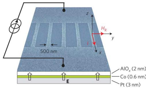
**Figure I.26** – Montage de l'expérience de Miron et al. [21]. L'image des nanofils a été effectuée au microscope électronique à balayage. Les flèches rouges sur les axes du repère représentent le courant électrique  $\mathbf{I}$  produit par le générateur et le champ Rashba de type champ effectif  $\mathbf{H}_R$ . Les flèches blanches représentent le champ électrique  $\mathbf{E}$ ; son sens a été déduit de l'expérience.
