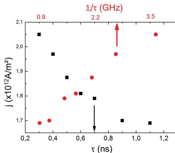
**Figure III.11** – Simulation micromagnétique de la densité de courant critique de retournement de l'aimantation en fonction de l'inverse de la durée de l'impulsion de courant dans la piste de tantale en prenant en compte une température finie de 300 K. L'amortissement vaut 0,1.
