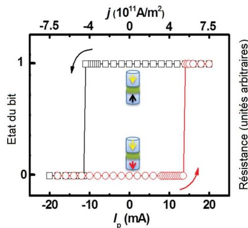
**Figure I.9** – État du bit en fonction de l'intensité du courant d'écriture pour une piste de tantale de largeur  $1,3 \mu\text{m}$  surmontée d'un plot magnétique de diamètre  $1 \mu\text{m}$ . Le courant est injecté sous forme d'impulsions de 50 ns dans la piste de tantale de la cellule SOT-MRAM [25]. Les flèches rouge et noire représentent l'aimantation du matériau ferromagnétique adjacent au tantale et les flèches jaunes le CoFeB le plus éloigné de la piste de tantale.
