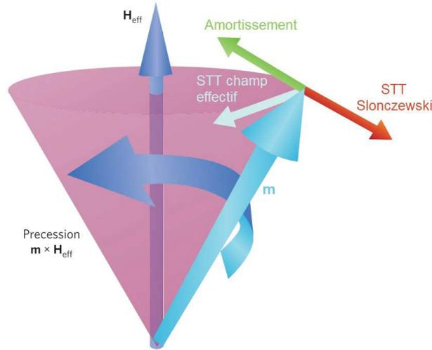
**Figure I.19** – Schéma des couples s'exerçant sur l'aimantation normalisée  $\mathbf{m}$  décrits dans l'équation (I.18). On suppose que le courant de spin est positif :  $\mathbf{I}_s > 0$ . Si le courant est de sens opposé les couples auront un sens opposé à celui présenté.  $\mathbf{H}_{eff}$  est le champ magnétique effectif [44].
