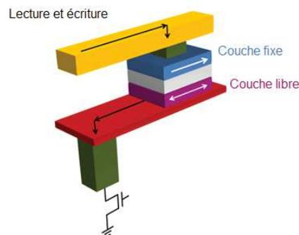
**Figure I.7** – Schéma d’une cellule STT-MRAM avec les deux matériaux ferromagnétiques et leurs moments magnétiques (flèches blanches), et la barrière tunnel en gris clair. Les flèches noires représentent le chemin du courant pour l’écriture et la lecture. Le transistor d’adressage est représenté en noir par un symbole électrique en bas de la figure.
