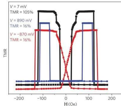
**Figure I.37** – Cycles majeurs de magnétorésistance d'une jonction tunnel magnétique en champ magnétique perpendiculaire au plan des couches minces mesurées à différentes valeurs de la tension appliquée sur l'échantillon [112].
