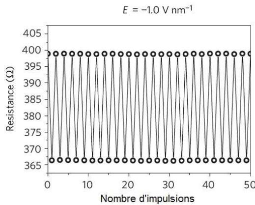
**Figure I.36** – Magnétorésistance tunnel en fonction du nombre d’impulsions de 0,55 ns [111]. Chaque impulsion permet de retourner l’aimantation, ce qui prouve le principe d’écriture de la cellule mémoire.
