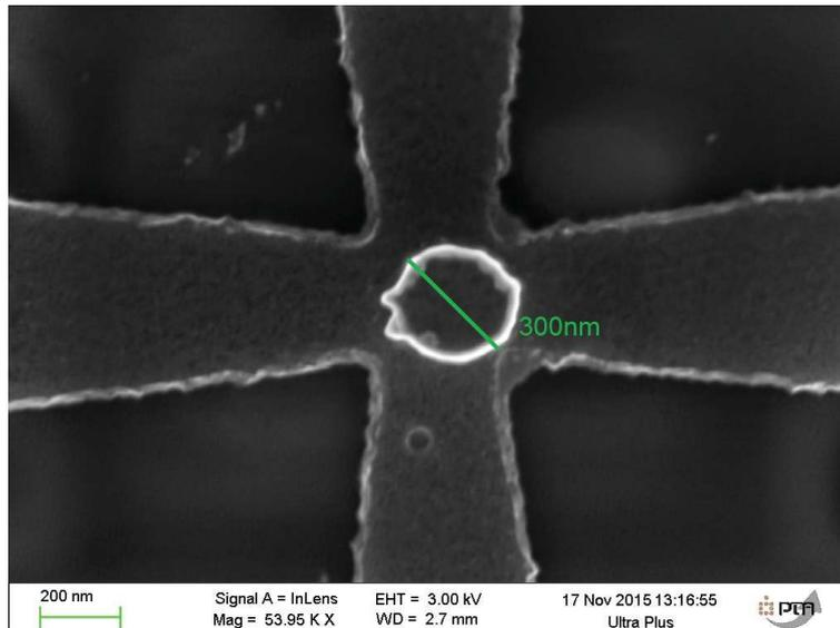
**Figure III.1** – Image au microscope électronique à balayage d'un plot magnétique circulaire surmonté de MgO. Les bras de la croix de Hall sont en tantale. Ce type d'échantillon est utilisé dans toute la partie III.1.
