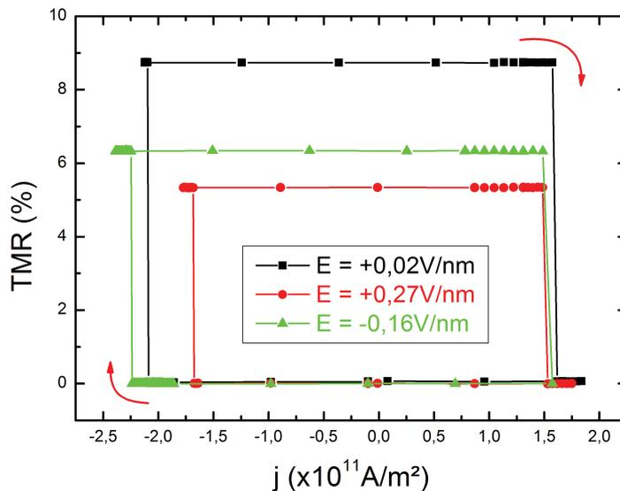
**Figure IV.13** – Cycles d’hystérésis mesurés au moyen du signal de TMR en fonction de la densité de courant  $j$  dans la piste de tantale. Les impulsions de courant durent 20 ns et le champ magnétique planaire est constant de valeur +200 Oe. Les différentes couleurs codent pour les différentes valeurs de champ électrique  $E$  et les flèches courbes indiquent le sens de parcours du cycle en partant de  $j = 0$ .
