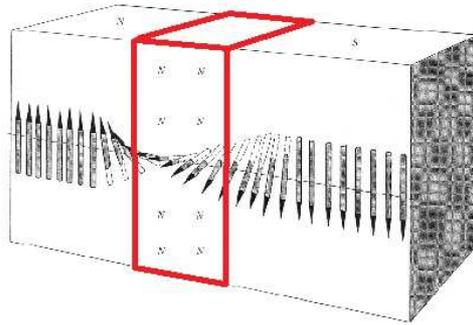
**Figure I.11** – Paroi de domaine entre deux domaines magnétiques (la paroi est matérialisée par les lignes rouges).
