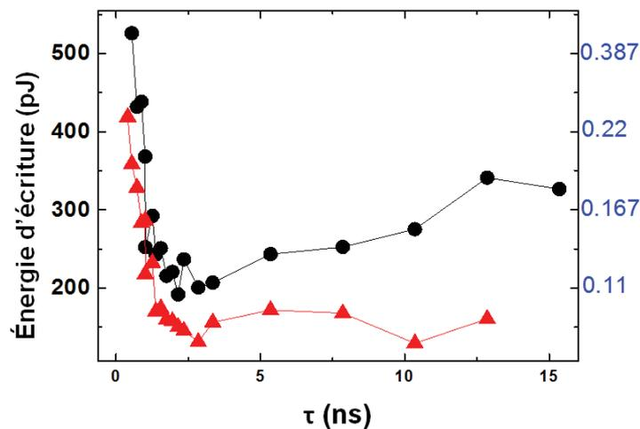
**Figure III.13** – Énergie d'écriture en fonction de la durée d'impulsion. Les points noirs (triangles rouges) ont été mesurés avec un champ magnétique extérieur de 1 kOe (1,5 kOe). L'échelle en bleu à droite est en pJ et correspond à une extrapolation des résultats pour une épaisseur de la piste de tantale de 3 nm et une largeur de 50 nm.
