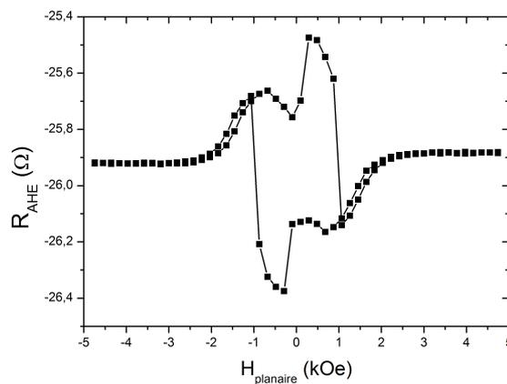
**Figure IV.2** – Cycle d’hystérésis effectué avec un champ magnétique extérieur appliqué parallèlement au plan des couches minces pour un échantillon de  $8 Ta/1,05 Co_8Fe_{72}B_{20}/MgO/5 Ta/5 Ru$ .
