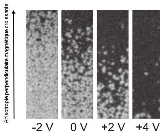
**Figure I.41** – Images au microscope à effet Kerr d'une même tricouche de Co/AlOx/ITO. L'application d'une tension positive réduit la probabilité de nucléations alors qu'une tension négative l'augmente. La tension positive correspond à des charges + sur l'ITO [113].
