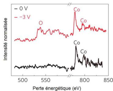
**Figure I.43** – Spectres STEM-EELS du centre de la couche de cobalt [122]. La courbe noire à 0 V correspond à la référence : il n'y a que du cobalt présent. La courbe rouge montre la présence d'oxygène lorsqu'une tension négative est appliquée (pic vers 530 eV présent sur la courbe rouge, absent sur la courbe noire).
