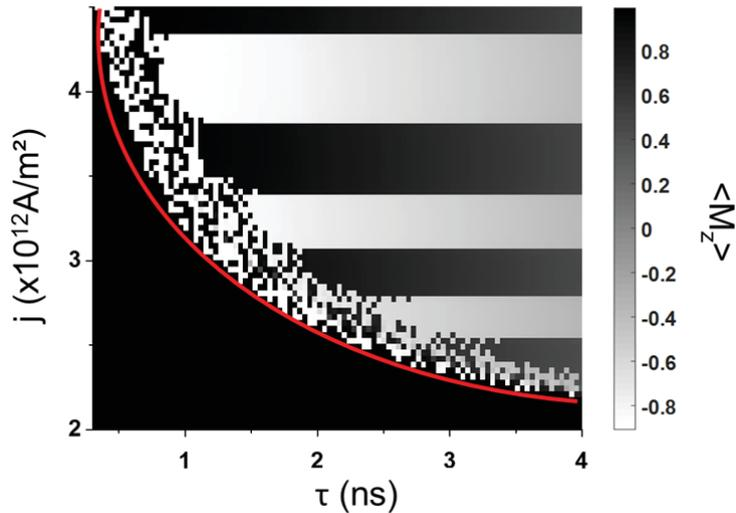
**Figure III.7** – Simulation macrospin à 0 K de la densité de courant injectée en fonction de la durée de l'impulsion. Le noir code pour une aimantation  $\uparrow$  et le blanc pour une aimantation  $\downarrow$ . La ligne rouge est un guide qui définit la densité de courant critique à partir de laquelle commence le retournement de l'aimantation.
