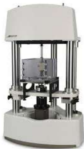
Figure2-4 : Machine Bose de traction et cuve permettant un bain marie (tiré de la notice Bose) Protocole
