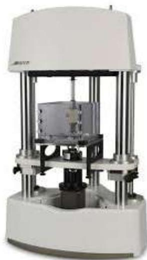
Figure2-4 : Machine Bose de traction et cuve permettant un bain marie (tiré de la notice Bose)
