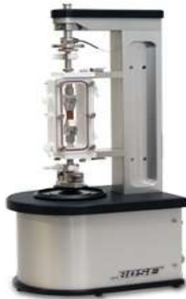
Figure2-5 : Machine Bose servant à la dilatation radiale (tiré de la notice Bose)
