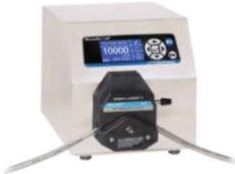
Figure2-14 : Pompe à galets utilisée pour les expériences à Amiens
