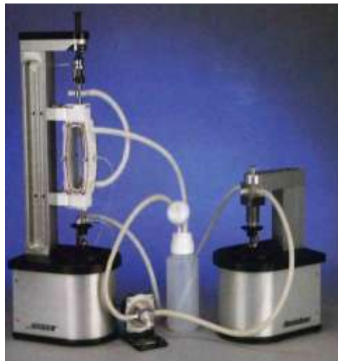
Figure2-7 : Montage du dispositif avec l'assemblage de la pompe (tiré de la notice Bose)
