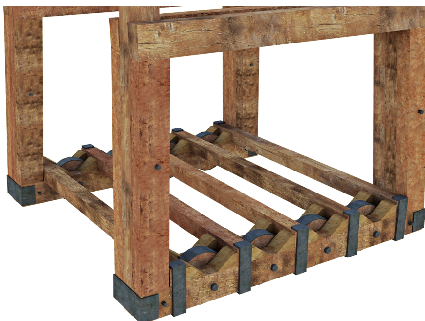
Figure 47 : Types de fixations utilisées sur la tour d'Apollodore de Damas
