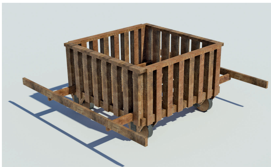
Figure 84 : Base, « antennes » et « cage » de la tortue de terrassiers selon les dimensions de Vitruve
