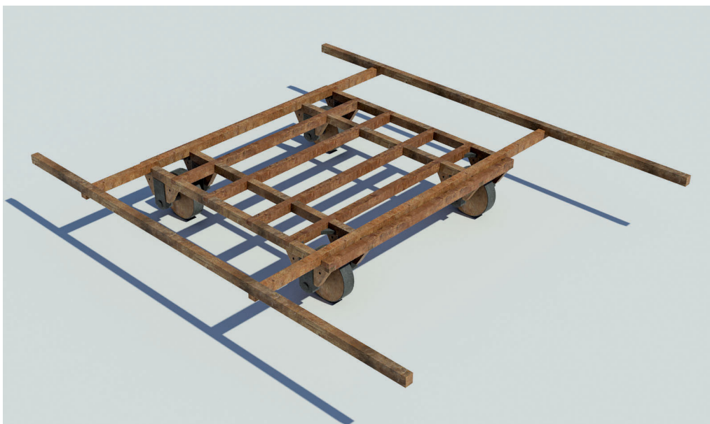
Figure 82 : Base et « antennes » de la tortue de terrassiers selon les dimensions d’Athénée le Mécanicien
