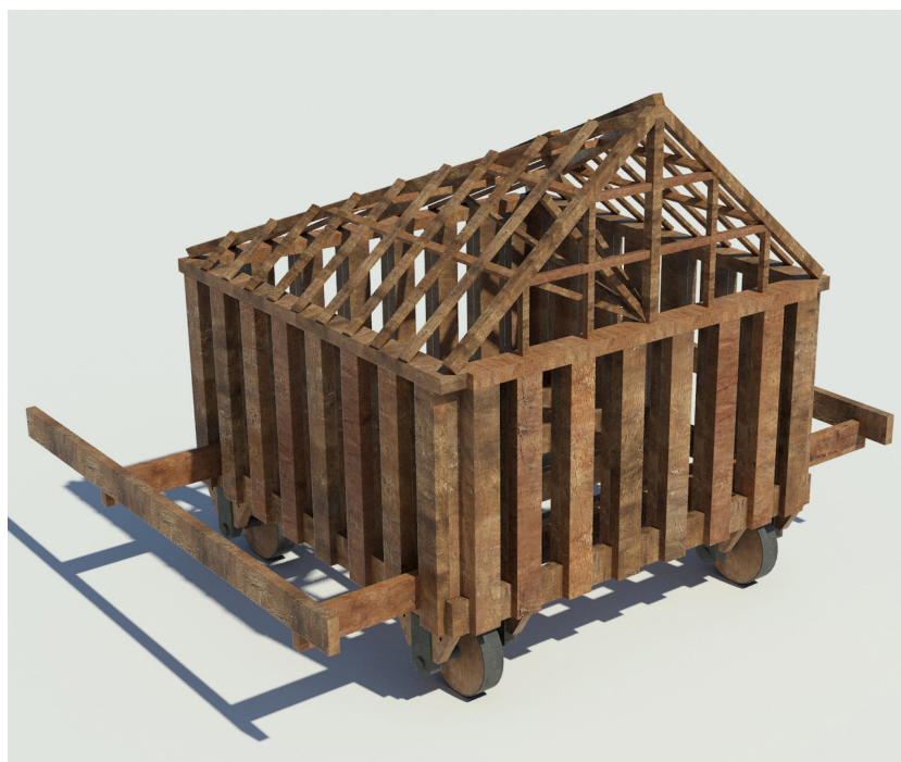
Figure 92 : Hypothèse de restitution de la tortue de mineurs avec un toit pyramidal (Vitruve)
