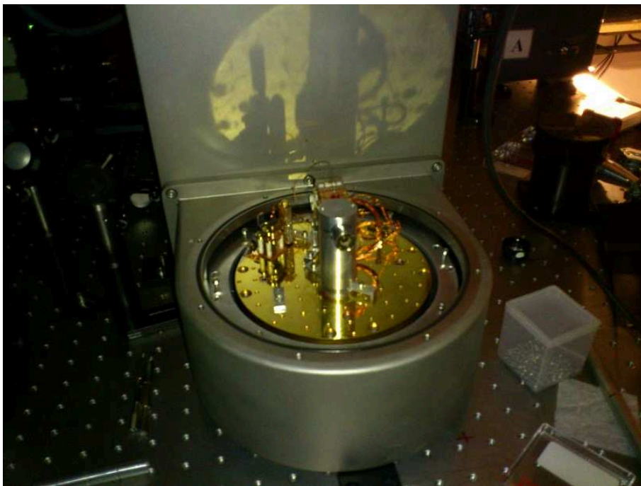
Figure 2.3.1: Emplacement de l'échantillon dans le cryostat avec circulation fermée d'hélium. Le stack 3d de contrôleurs piézoélectriques Micronix est monté sur une platine froide en cuivre et se trouve derrière un objectif de microscope.
