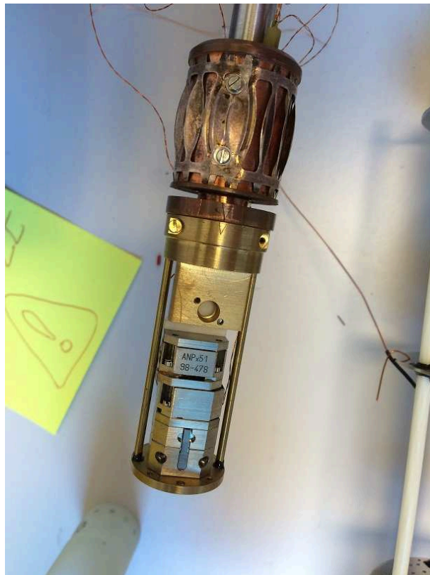
Figure 2.3.3: Stack 3d de contrôleurs piézoélectriques Attocube monté sur une canne porte-échantillon, avec une lentille asphérique montée dans un support en cuivre
