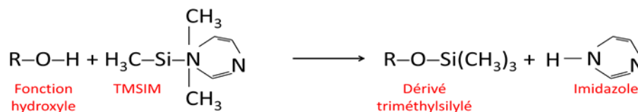
Figure 14: Réaction de dérivation des fonctions hydroxyles par le TMSIM
