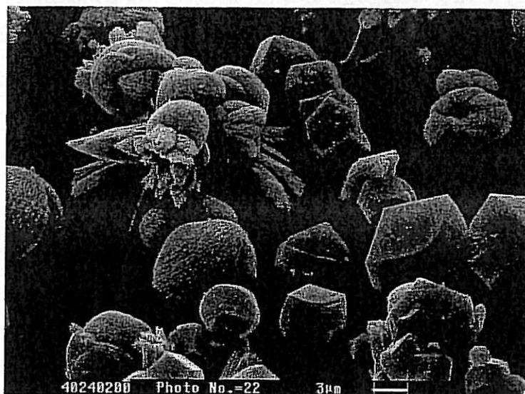
*Photo 3: Calcite et vaterite et aragonite précipité en solution sulfatée.*
