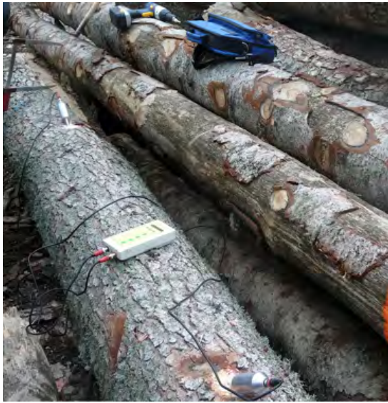
(a) Mesure par la méthode de vitesse de propagation d'ondes ultrasonores au moyen du Sylvatest (cbs-cbt). Crédit : sillon38.
