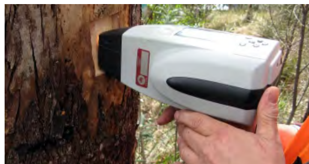
FIGURE 1.10 – Acquisition du spectre infra-rouge avec une SPIR portable. Crédit : Forest Quality Pty Ltd
