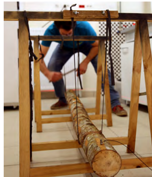
(b) Mesure par analyse vibratoire sur un rondin. Crédit : IRSTEA.
