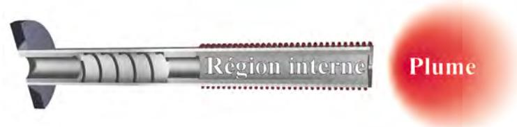
Figure III-15 : Illustration de la cathode NASA NSTAR et de deux régions physiquement différentes : la région interne et la plume.
