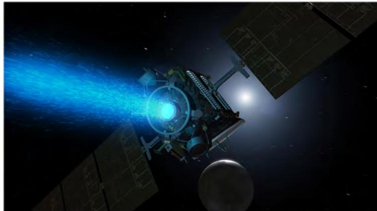
Figure I-1 : Vue d'artiste du propulseur à grille (descendant du propulseur NSTAR développé par la NASA) qui équipe la sonde spatiale Dawn (Crédit image : NASA/JPL-Caltech)
