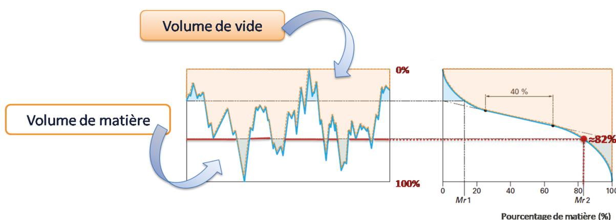
Figure 69 : Schéma explicatif du mode de construction des courbes d'Abbott [114].
