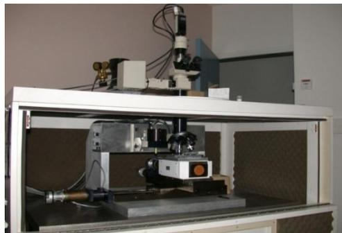
Figure 34 : Photo du Nano Indenteur II MTS.
