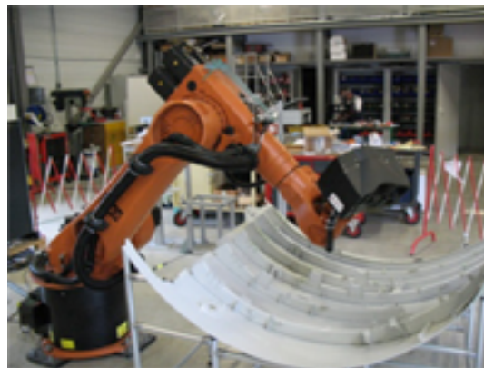
(b) Robot portant le capteur double tête stéréo en face de l'assemblage réel
