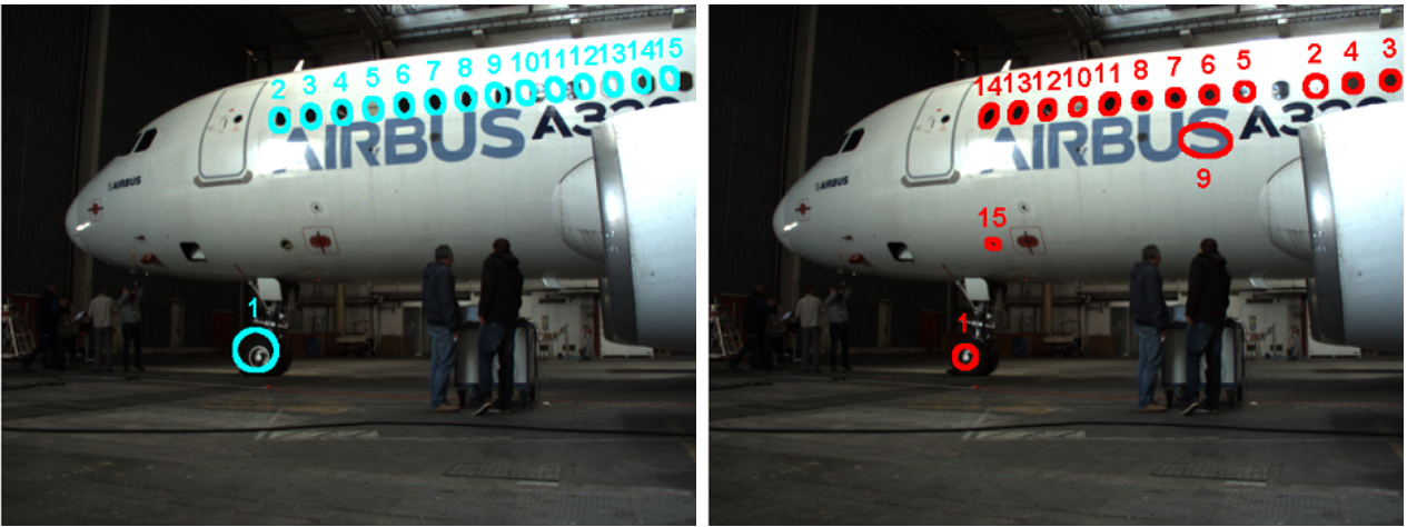
(a) Projection des primitives CAO (ellipses) sur l'image (b) Ellipses détectées dans l'image acquise avec la caméra PTZ.
