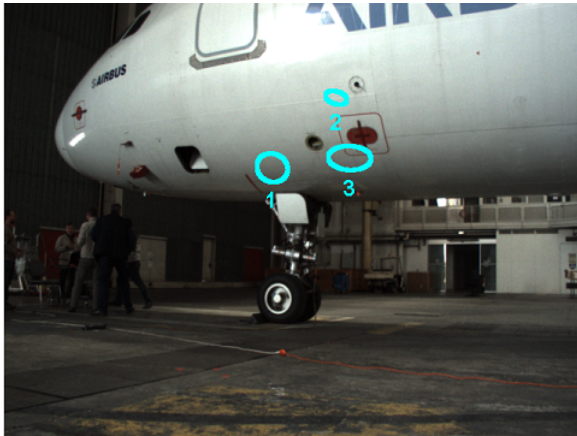
(a) Projection des primitives CAO (ellipses) sur l'image acquise avec la caméra PTZ.
