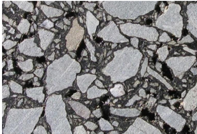
Figure 2-2 Coupe d'un enrobé bitumineux de type « Béton Bitumineux Semi Grenu » (BBSG) au bitume pur (Q.T. Nguyen, 2011)
