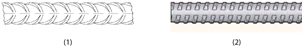
Figure 13 Différents types de barre haute adhérence (HA) (1) barre HA à verrous pour le béton armé (NF EN 10080: 2005) (2) barre HA à filetage pour les ancrages au rocher
