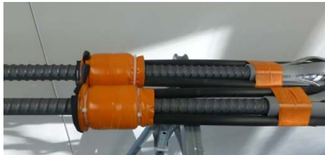
Figure 175 Barre d'ancrage équipée de canules d'injections
