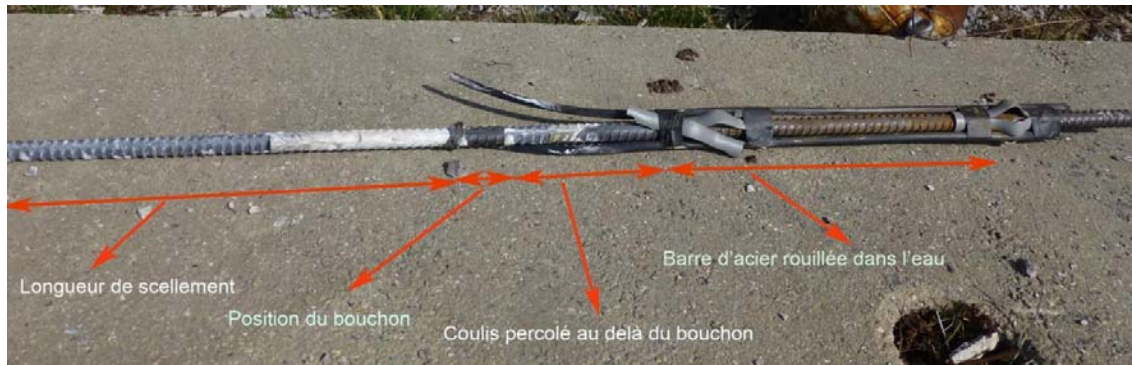
Figure 392 Barre d'acier arrachée de l'essai n°14.3
