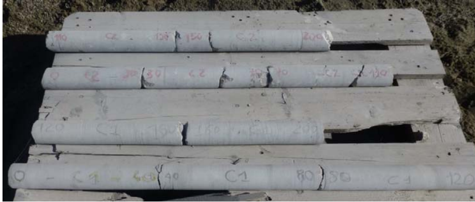
Figure 170 Echantillons des sondages carottés C1 et C2
