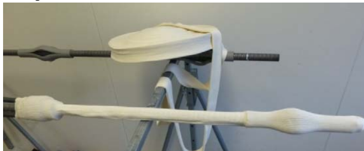
Figure 176 Barre d'ancrage équipée de la chaussette géotextile
