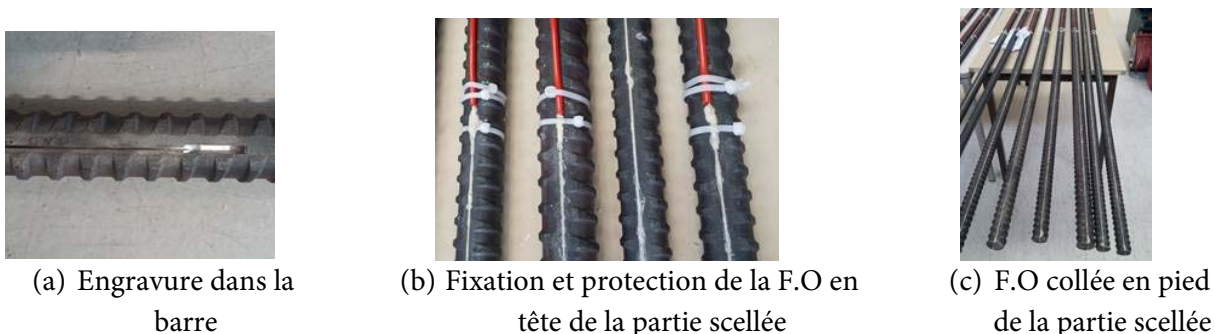
Figure 179 Équipement d'une barre d'acier avec une fibre optique
