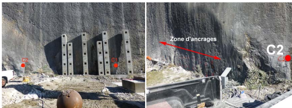
Figure 169 Zones de prélèvement d'échantillons de roche par sondage carotté
