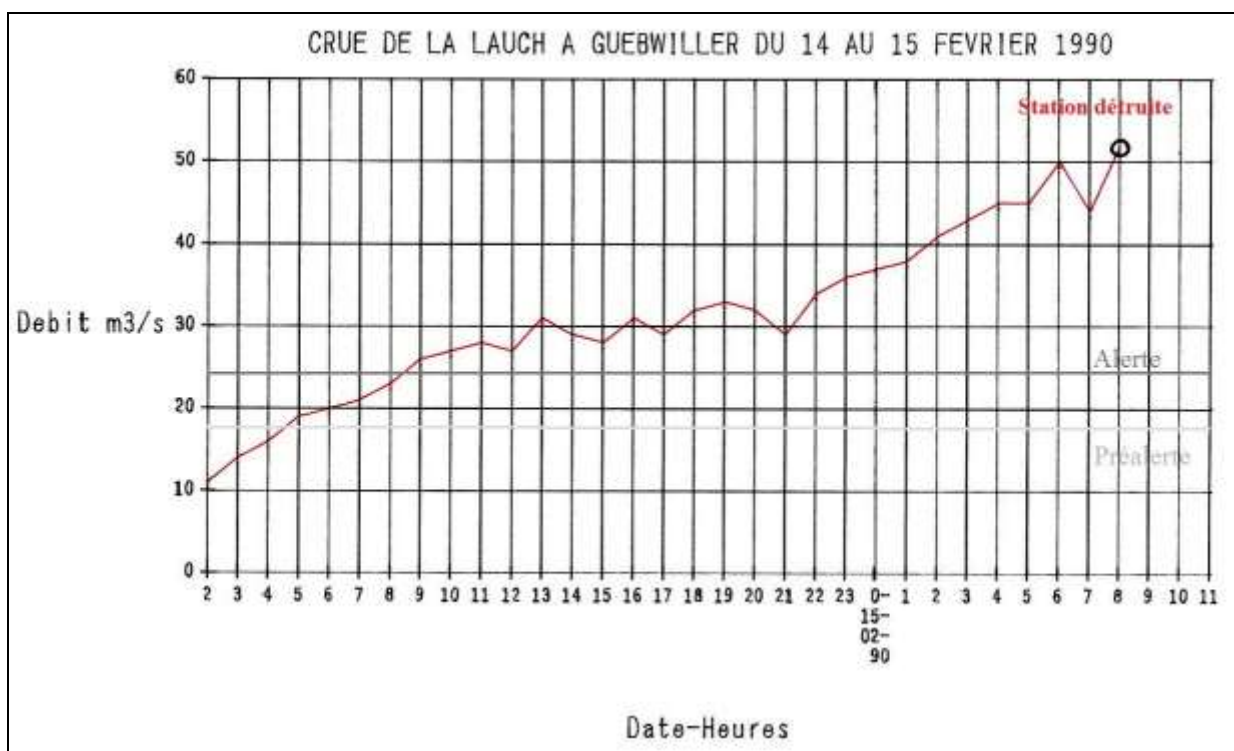
Figure 19 : Débit de la Lauch enregistré à la station de Guebwiller au courant de la crue de février 1990 (Source : Archives DDT 68, DDAF 68, Crue de la Lauch à Guebwiller du 14 au 15 février 1990)-16
