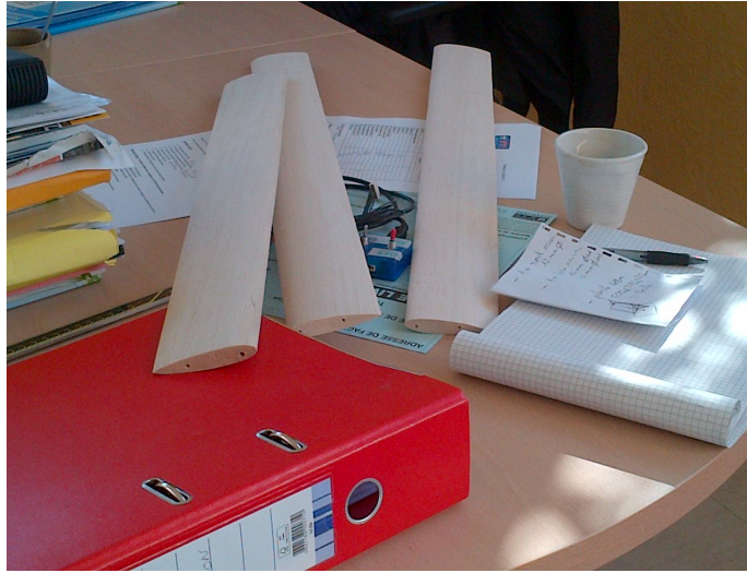
FIGURE 6.7 – Pales en balsa, profil NACA0018
