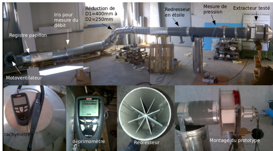
FIGURE 5.14 – Photomontage du banc d'essais et des outils de mesure
