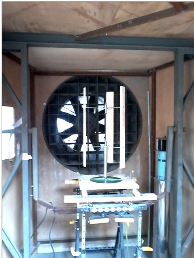
FIGURE 6.8 – Éolienne à échelle 1
