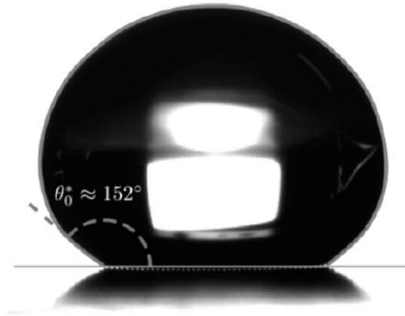
Figure I.17 Mesure d'angle de contact d'une goutte d'eau déposée sur une surface superhydrophobe
