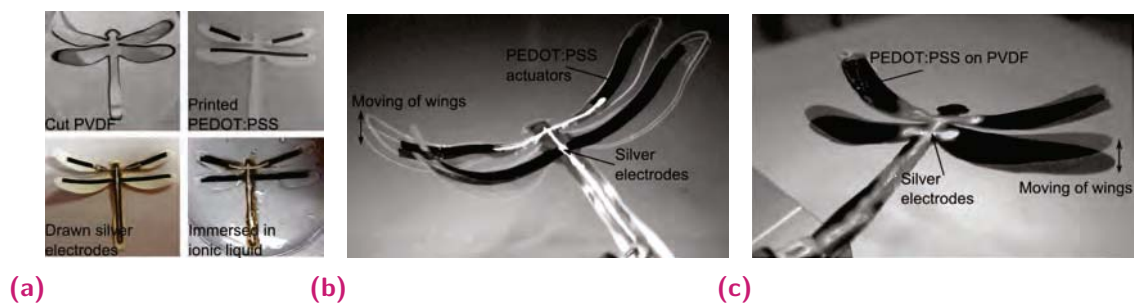
Fig. C.23. (a) Etapes de fabrication pour des actionneurs imprimés: (1) une membrane de PVDF est découpée à la forme désirée; (2) les actionneurs rectangulaires de PEDOT: PSS ont été imprimés sur chaque côté de la membrane dans la zone où l'actionnement est souhaité; (3) des zones en pâte d'argent sont déposées pour connecter les différentes électrodes; (4) la membrane PVDF est imprégnée avec le liquide ionique. Images fusionnées de deux positions d'actionnement ( \pm 2 V à 1 Hz ) d'une libellule avec des actionneurs (b) imprimés et (c) actionneurs obtenus dépôt de goutte et découpe.
