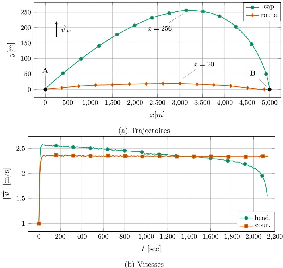
FIGURE 4.5 – Trajectoire et vitesse pour des correcteurs de cap et de route
