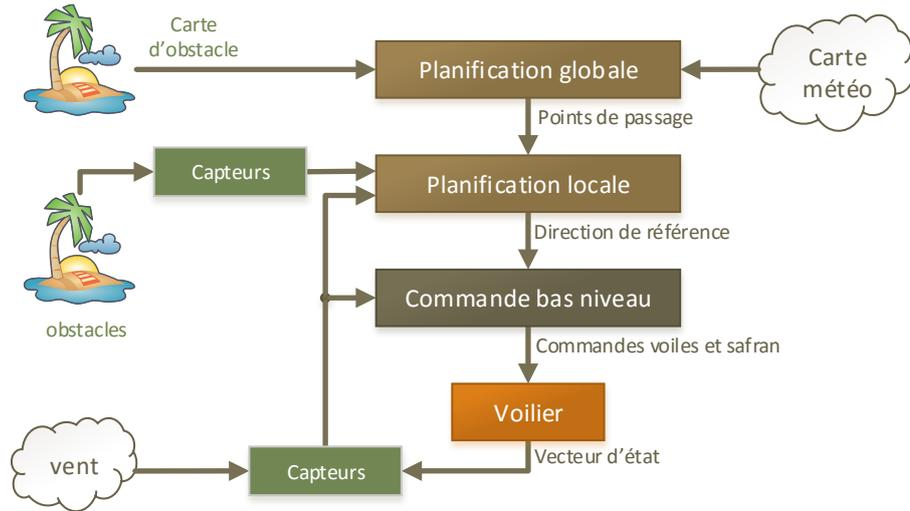
FIGURE 2.1 – Schéma de la hiérarchie de commande du voilier Asarome II
