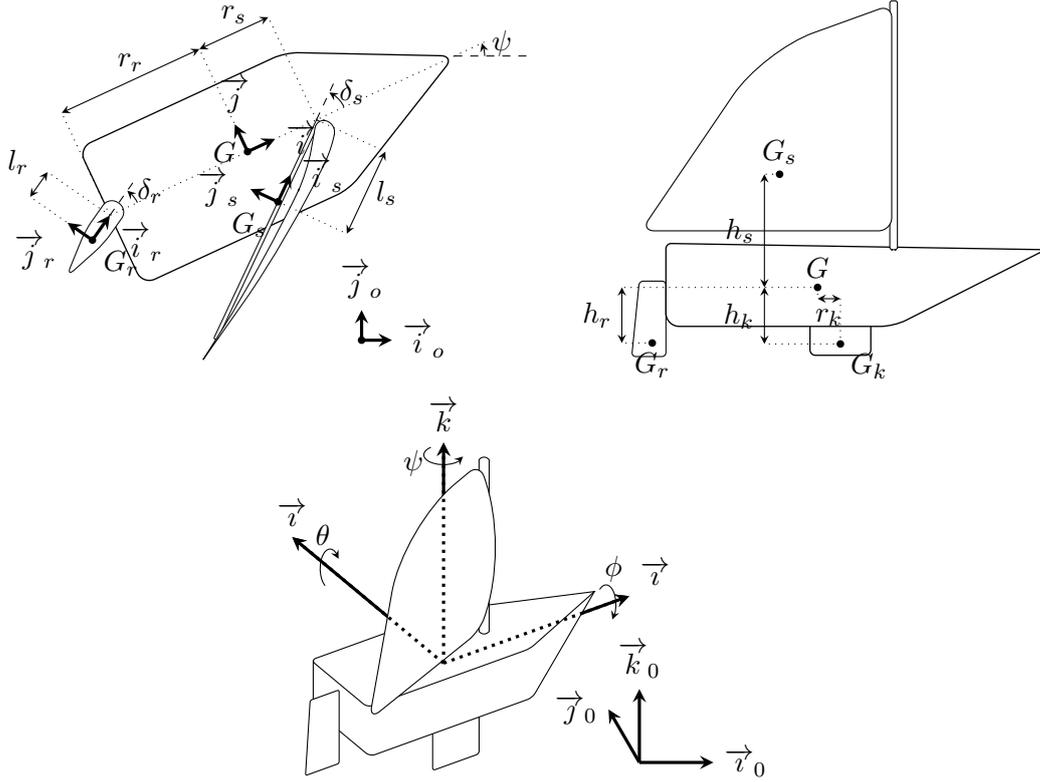
FIGURE 3.2 – Repères et paramètres géométriques du voilier
