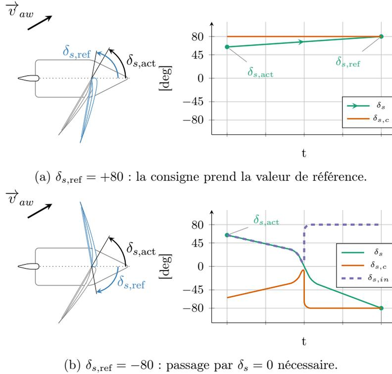
FIGURE 5.13 – Manœuvre de changement de bord
