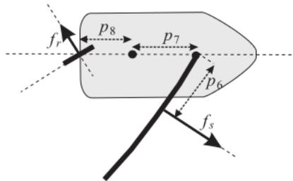
FIGURE 1.4 – Modèle [Jaulin, 2004] - coefficients géométriques
