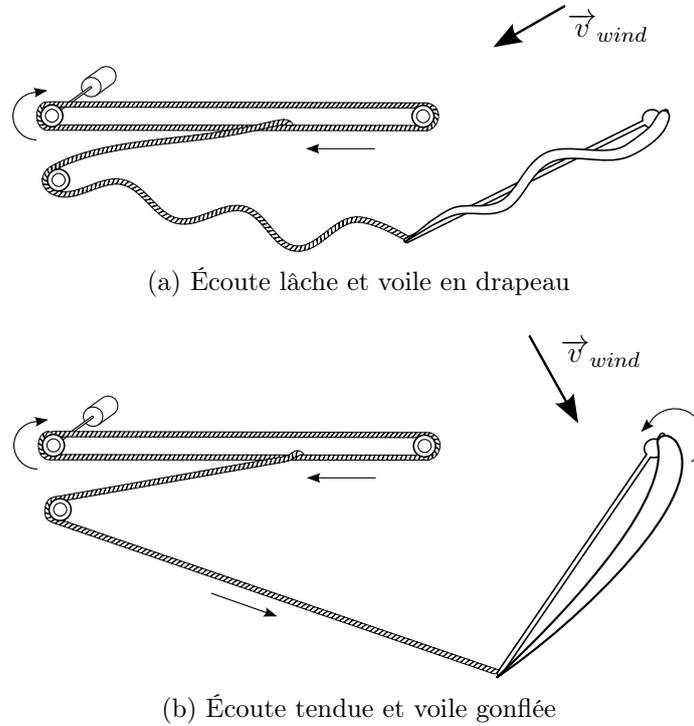
FIGURE 3.7 – Mécanisme d'écoute pour l'actionnement de voile
