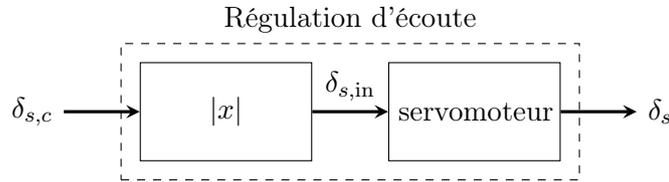
FIGURE 5.12 – Schéma-bloc du réglage d'écoute
