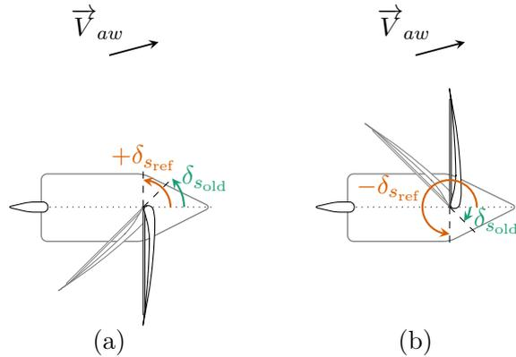
FIGURE 3.9 – Évolution de la voile en fonction du vent, de  $\delta_{s_{\text{ref}}}$  et de  $\delta_{s_{\text{old}}}$ . a) la voile reste gonflée et converge vers  $+90^\circ$ , b) la voile reste gonflée et converge vers  $-90^\circ$
