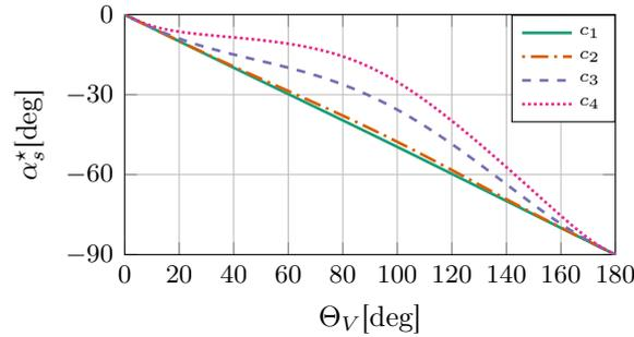
(c) Angle d'attaque optimal  $\alpha_s^*$  en fonction de l'angle de vent apparent  $\Theta_V$
