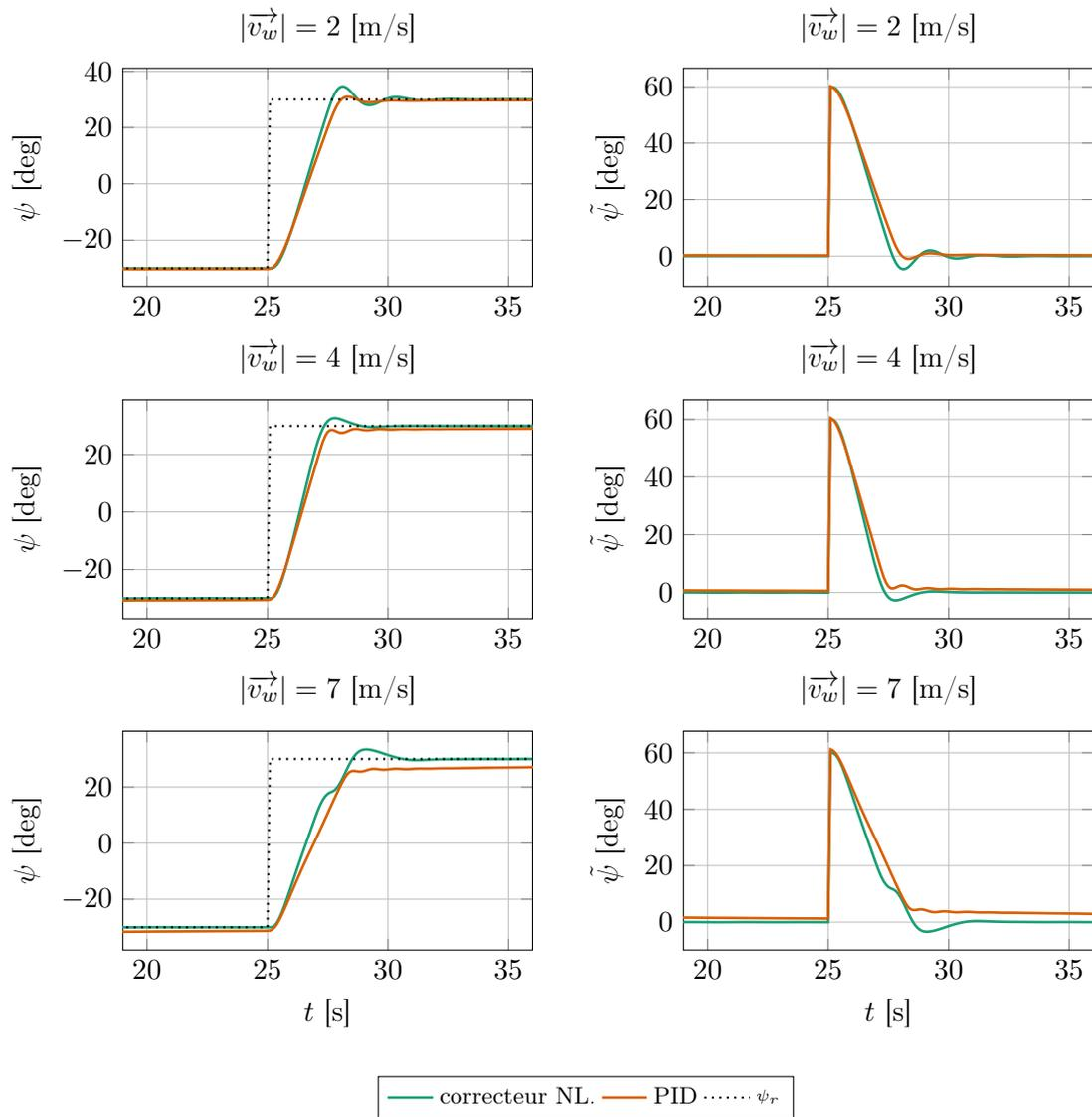
FIGURE 4.7 – Comparaison entre contrôleurs de cap (non linéaire vs. PID) à différentes vitesses de vent
