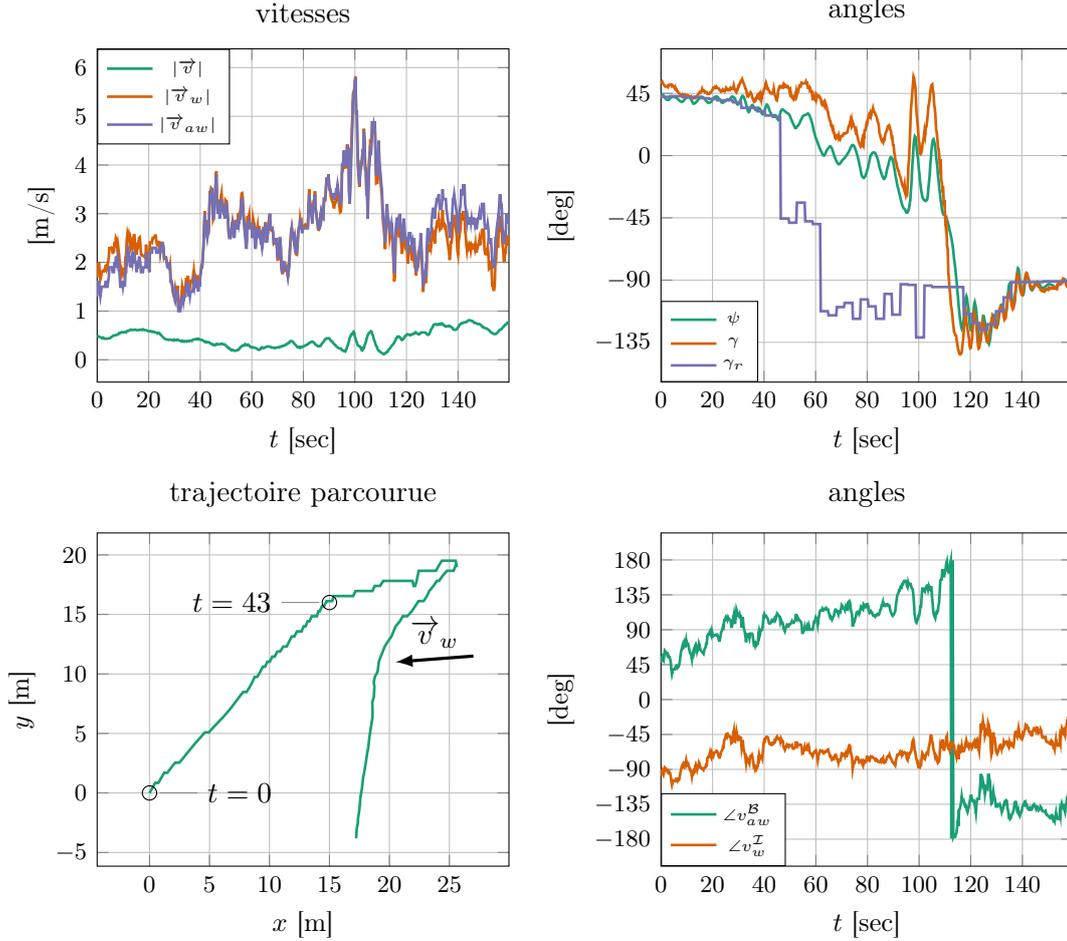
FIGURE 6.2 – Chute de vitesse et perte de maniabilité lors d’une remontée au vent pendant une expérience
