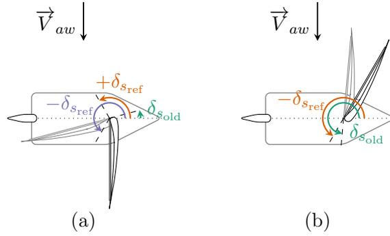
FIGURE 3.8 – Évolution de la voile en fonction du vent, de  $\delta_{s_{\text{ref}}}$  et de  $\delta_{s_{\text{old}}}$ . a) la voile devient lâche et suit le vent, b) la voile reste gonflée et converge vers  $-120^\circ$
