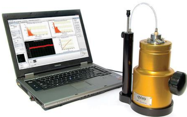
Figure 14 – Aperçu du dispositif qNano commercialisé par Izon Science ainsi que du logiciel de pilotage et de traitement de données.
