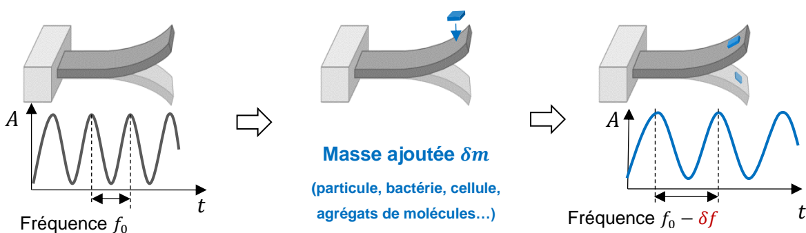
Figure 25 – Schéma explicatif du fonctionnement d'un MEMS résonant en tant que capteur de masse. Le paramètre mesuré est la fréquence de résonance du système, qui varie en fonction de sa masse effective. Lorsqu'une particule (par exemple une cellule biologique, un virus...) se dépose sur l'oscillateur, l'alourdissement provoqué par cet objet a pour conséquence de diminuer la fréquence de l'oscillateur ; en mesurant donc le décalage en fréquence, il est possible d'extraire la masse déposée sur le capteur.
