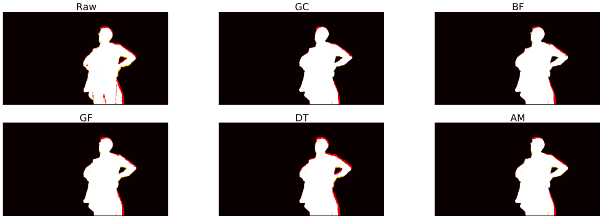
FIGURE 3.28 – Visualisation de l'erreur F -measure pour une image du clip 7 ( \sigma_r = 20 et \sigma_s = 0.1 ). En blanc les vrais positifs VP , en noir les vrais négatifs VN , en jaune les faux positifs FP , en rouge les faux négatifs FN . Dans l'ordre : segmentation grossière issue de l'algorithme proposée par la Kinect (Raw), Graph Cut (GC), filtre bilatéral (BF), filtre guidé (GF), domain transform (DT), adaptive manifolds (AM)
