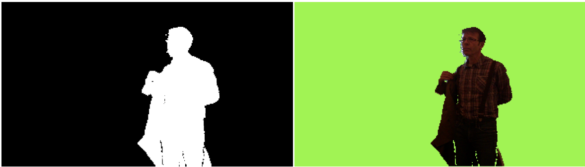
FIGURE 3.14 – Compositing brut. Gauche : segmentation brute de la silhouette. Droite : compositing de l'image film avec la segmentation brute. On note un mauvais alignement local des contours sur certaines portions de la silhouette.
