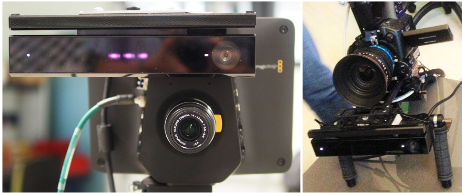
FIGURE 2.17 – Notre système couplant le capteur de profondeur Kinect 2 avec des caméras différentes. Gauche : Blackmagic Studio HD avec une optique 14mm. Droite : Panasonic AG-AF100A avec une optique 18mm.
