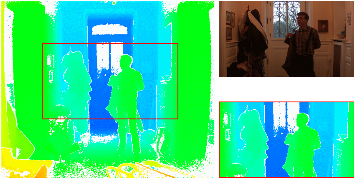
FIGURE 2.29 – Surface utile du capteur de profondeur. Le rectangle rouge dans l’image de profondeur brute correspond à la surface utile puisqu’il s’agit de la surface qui correspond au champ de vision de la caméra film. Il s’agit ici d’une estimation puisque les centres optiques des capteurs de profondeur et caméra film ne sont, en réalité pas confondus.
