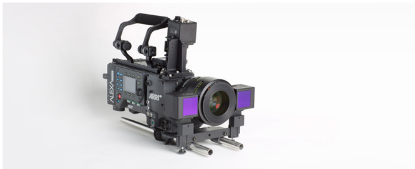
FIGURE 2.9 – Prototype d'une caméra professionnelle vidéo et profondeur RGBD, utilisant la technologie à temps de vol. Ce prototype est baptisé ARRI ALEXA SCENE (source http://www.arri.com/news/prototype-motion-scene-camera/ ).
