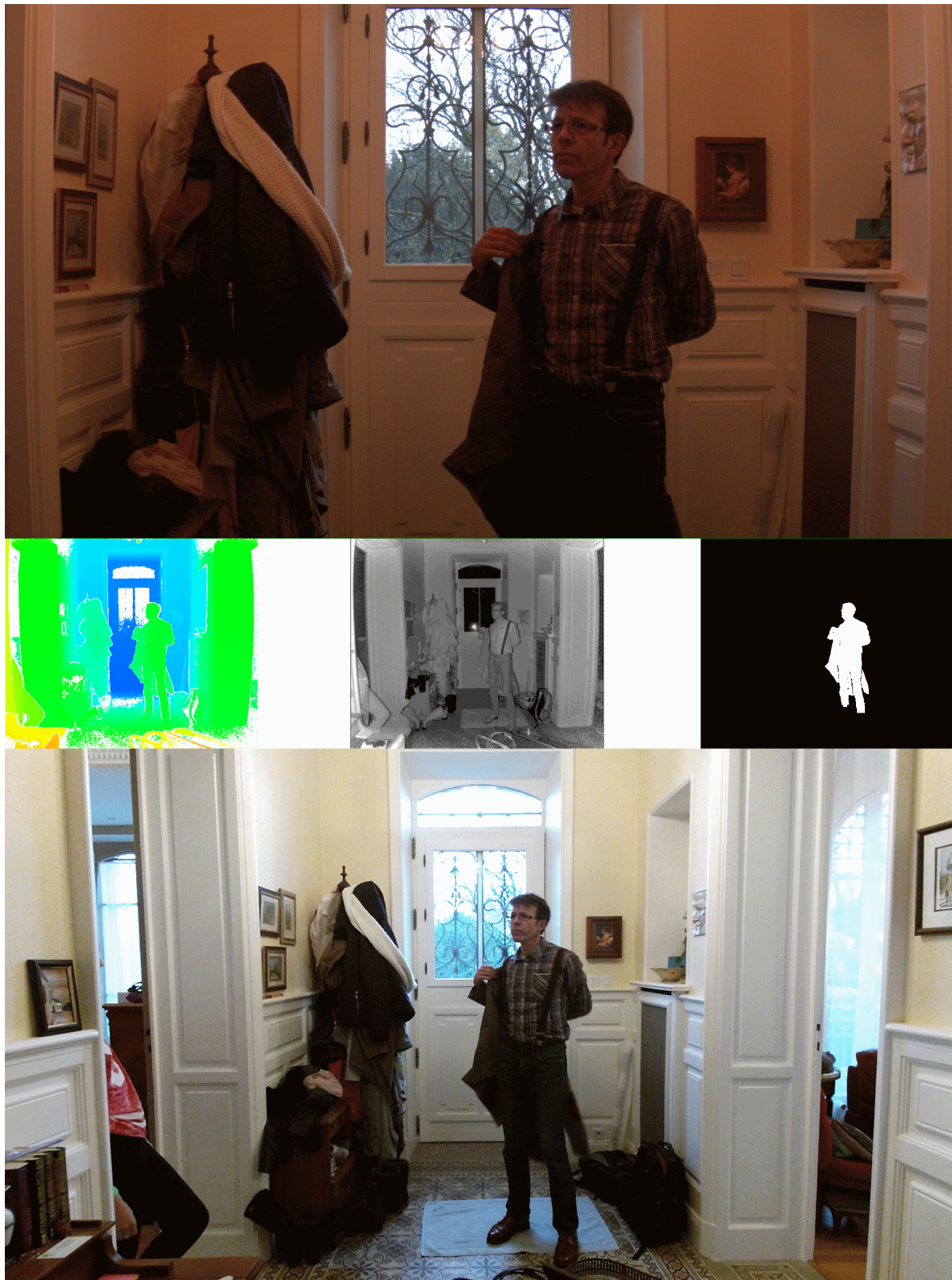
FIGURE 3.10 – Exemple de données extrait des différents flux. Haut : image extraite du flux film. Milieu gauche : image de la profondeur issue du flux depth (illustration en fausses couleurs pour permettre de distinguer les niveaux de profondeur). Milieu centre : image infrarouge issue du flux infrared (histogramme modifié pour permettre la visualisation). Milieu droite : masque binaire correspondant à la silhouette extrait du flux silhouette. Bas : image couleur de la Kinect issue du flux color .
