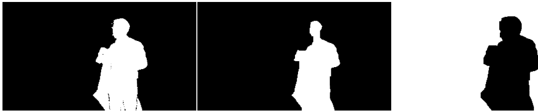
FIGURE 3.15 – Opérations morphologiques sur l'image de la segmentation brute. Gauche : image de la segmentation brute de la silhouette. Centre : masque du premier plan M_{brut,fg} obtenu par une érosion. Droite : masque brut de l'arrière plan M_{brut,bg} qui correspond au négatif de la dilatation.
