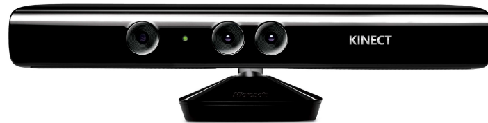
FIGURE 2.6 – Kinect 1 de Microsoft qui utilise la technologie Primesense de lumière structurée. La Kinect 1 est capable d'acquérir une carte de profondeur d'une résolution de 640 \times 480 pixels avec une fréquence de 30Hz .
