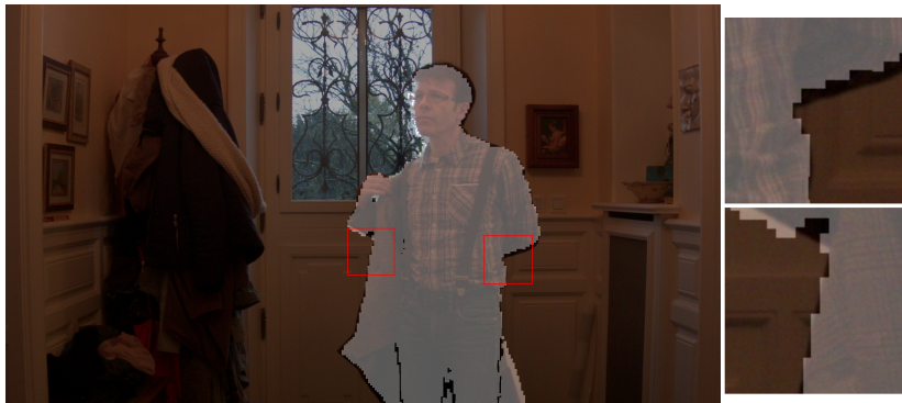
FIGURE 3.8 – Décalage entre le masque silhouette recalé et l'image film. Le masque silhouette issue de l'image de profondeur est recalée spatialement avec l'image film en utilisant la méthode de reprojection. Le masque est superposé avec l'image film. On note localement des décalages de contours. Il est à noter qu'un filtrage gaussien permettrait de lisser le crénelage du masque, cependant celui-ci ne résout pas le décalage de contours avec l'image couleur.
