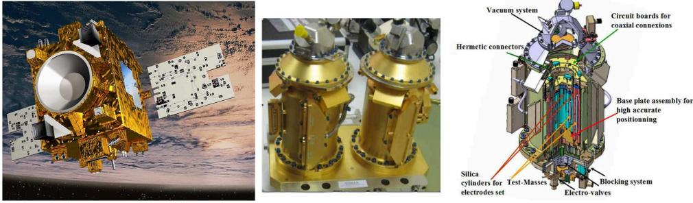
Figure 1.18 – Vue d’artiste du satellite MICROSCOPE (à gauche), photographie des accéléromètres (au centre), vue en coupe des accéléromètres (à droite). Source : CNES et ONERA.
