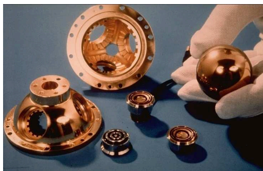
Figure 1.11 – Photographie des composants de l’accéléromètre CACTUS (à gauche) et Schéma du principe de fonctionnement d’un axe sensible (à droite), source : ONERA.
