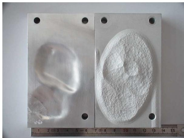
Figure 31 : Comparaison visuelle avant et après réalisation du revêtement elliptique sur le second type de défaut
