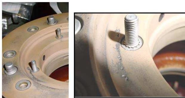
Figure 2 : Corrosion sur zone indiquée - face appui porte joint et centrage roulement sur carter Magnésium
