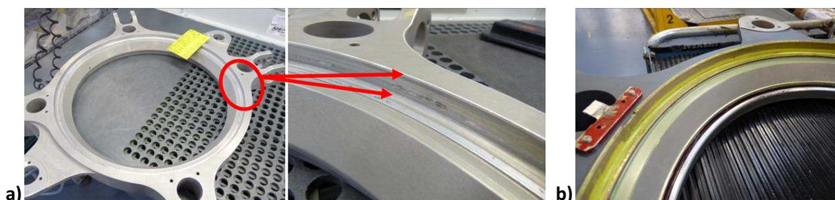
Figure 3 : a) Présence de trace de corrosion et de fretting sur plateau cylindrique en alliage d'aluminium et b) réparation actuelle par frettage (bague acier)
