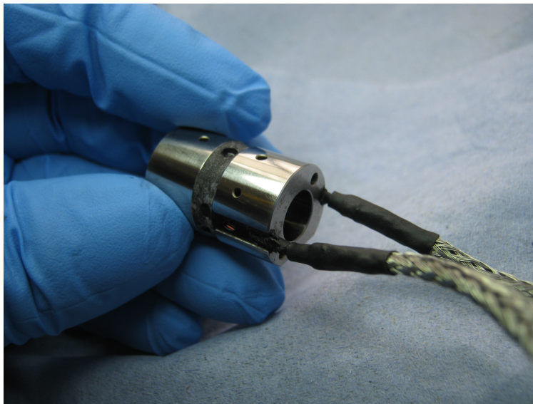
FIGURE 5.4 – Photographie du palier instrumenté par les capteurs ultrasons
