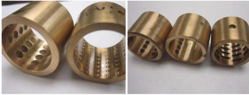
FIGURE 1.11 – Paliers grossièrement texturés par usinage (à gauche) et gravure à (droite) ([90])
