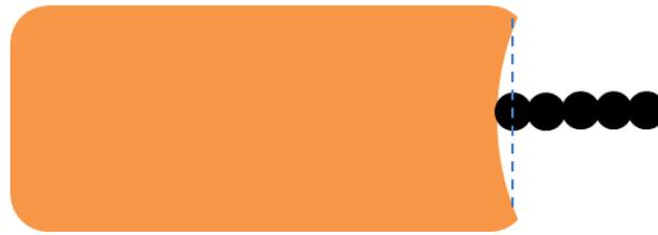
FIGURE 3.27 – Schéma de principe de l'expérience d'estimation des bords d'un cylindre. Les billes noires représentent des billes MyOnes de  $1.1 \mu\text{m}$  de diamètre, le rond blanc correspond à leur centre connu très précisément en faisant le focus sur le haut des billes et en prenant le barycentre des pixels pondéré par leur intensité. Ceci permet d'en déduire la position exacte du bord du cylindre.
