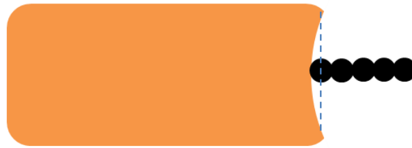
FIGURE 3.27 – Schéma de principe de l'expérience d'estimation des bords d'un cylindre. Les billes noires représentent des billes MyOnes de 1.1 \mu\text{m} de diamètre, le rond blanc correspond à leur centre connu très précisément en faisant le focus sur le haut des billes et en prenant le barycentre des pixels pondéré par leur intensité. Ceci permet d'en déduire la position exacte du bord du cylindre.
