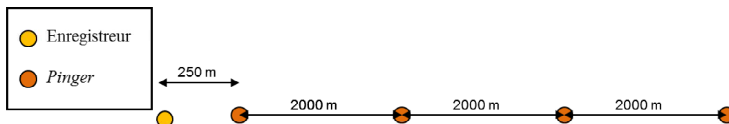
FIGURE 4.14 – Plan de la manipulation visant à tester les interférences du canal CDMA.
