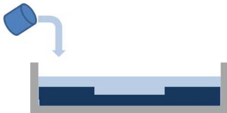
Figure A.2 – (A) Protocole de fabrication d'un substrat micro-structuré en PDMS, qui peut servir de contre-moule. (B) Silanisation du PDMS. (C) Réplication PDMS/PDMS. (D) Obtention du timbre en PDMS pour la fabrication de la NOA.
