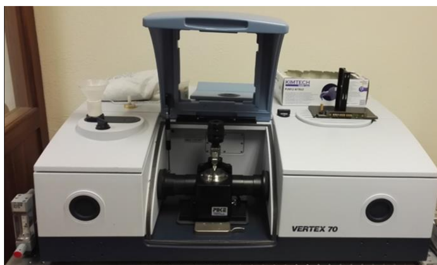
Figure 2.15 ATR-FTIR spectrometer (Laboratoire de Chimie Physique, LCP, Paris-Sud University).
