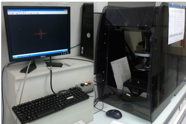
Figure 2.21 Surface profiler (Laboratoire de Physicochimie des Polymères et Interfaces, LPPI, Cergy-Pontoise University).
