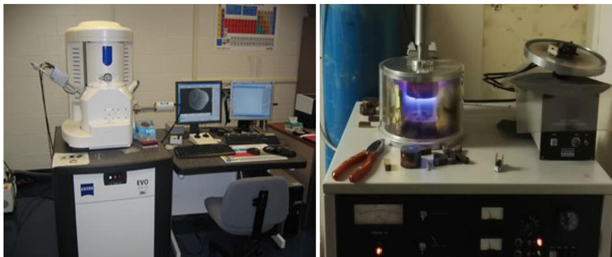
Figure 2.18 EVO MA10 SEM (left) and SC-6 Pelco Sputter Coater (Laboratoire Procédés et Ingénierie en Mécanique et Matériaux, PIMM, Conservatoire National des Arts et Métiers, CNAM, Paris).
