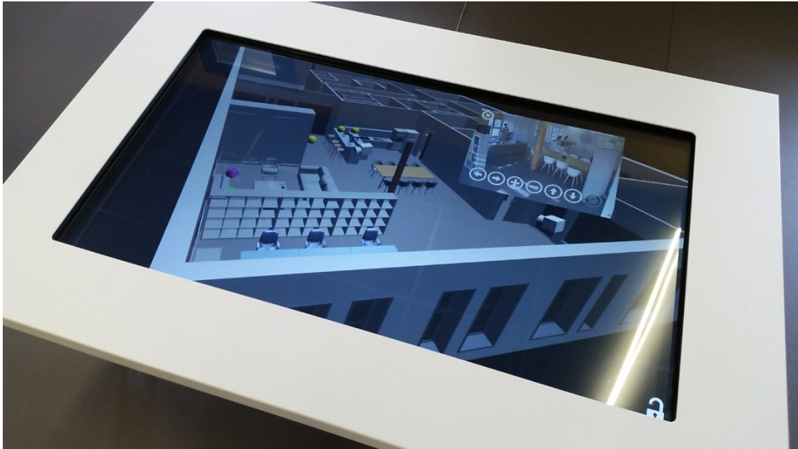
FIGURE 7.2 – Contrôle de l’environnement via la table basse tactile
