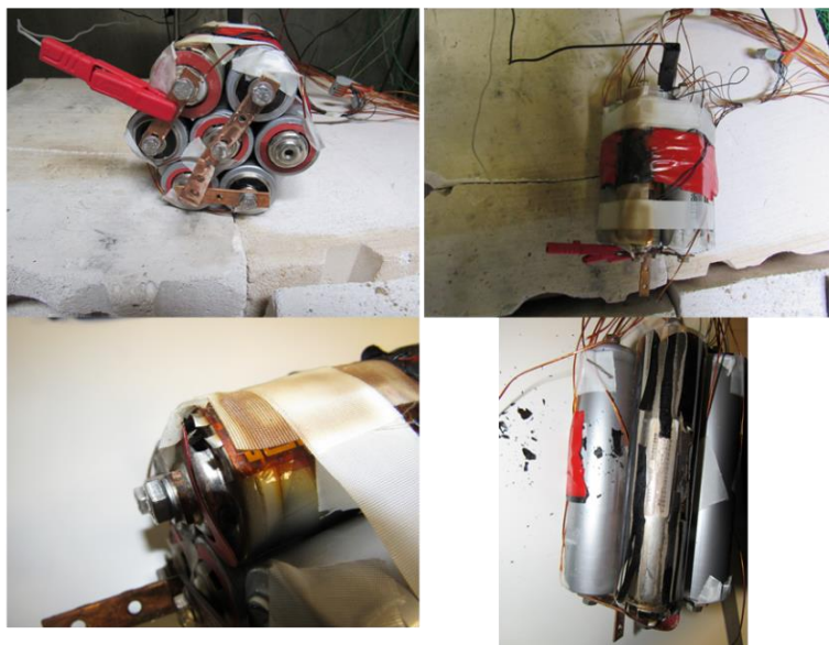
Figure 3.39. Clichés photographiques avant et après l'essai de surchauffe du module LifeBatt
