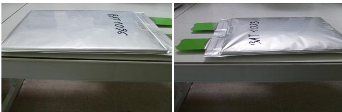
Figure 3.8. État des cellules PurePower après 10 % de vieillissement calendaire à 60°C et un SOC de 100%
