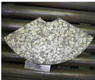
FIGURE III.1 – Un exemple de compact composé uniquement de copeaux métalliques d'alliage M5 ® .
