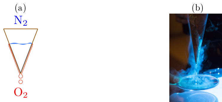
FIGURE D.2 – (a) Schéma du dispositif de condensation fractionnée pour liquéfier l'oxygène de l'air à partir d'azote liquide. (b) Photographie du dispositif magnifié lors de la performance 2080 du collectif Labofactory au vernissage de l'exposition Arts et Sciences, Le méridien climatique, à la Sorbonne en octobre 2015.
