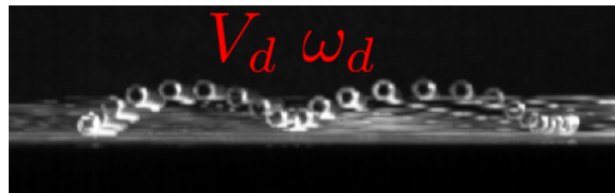
FIGURE 4.17 – Superpositions d'images de la dérive du cylindre creux sur la série de deux vagues. On observe deux oscillations identiques synchronisées avec le passage des deux vagues. \omega_d est la pulsation des oscillations de dérive de la particule et V_d est la vitesse moyenne de dérive de la particule.
