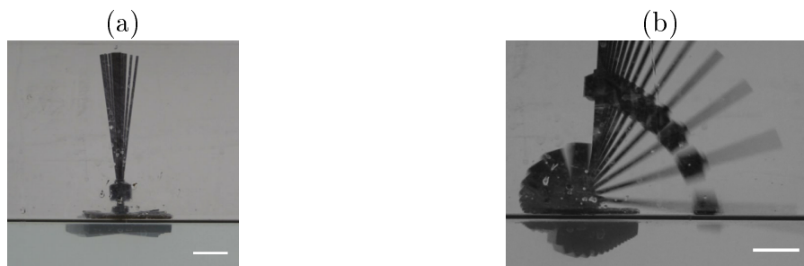
FIGURE 3.7 – Superpositions d'images pour une planche de dimensions L = 18.5 cm, l = 6.5 cm et e = 1.5 cm. Le pas de temps entre deux images est de 1/30 s, l'échelle représente 3 cm. La vitesse est nulle (limite statique). La hauteur de chute statique est h_G^* = 5 cm. (a) h_G = 2 cm < h_G^* . Le surfeur retrouve son équilibre : le système est stable. (b) h_G = 8.5 cm < h_G^* . Le surfeur perd l'équilibre : le système est instable.
