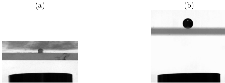
FIGURE 5.4 – Particule magnétique déposée à la surface d’une plaque de verre (d’épaisseur 3 mm) au-dessus de l’aimant permanent cylindrique de diamètre D = 3 cm (en noir). (a) La goutte d’oxygène liquide est une particule magnétique déformable mais à faible frottement. La distance entre la goutte et l’aimant est z = 1.1 cm. (b) La bille métallique solide est une particule magnétique indéformable mais en contact avec la plaque de verre (ce qui suppose des frottements solide-solide). La distance entre la bille et l’aimant est z = 2.4 cm.
