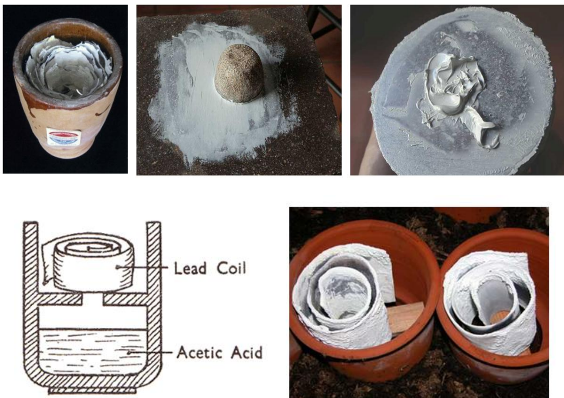
Figure I.1 : Quelques étapes de la fabrication du blanc de plomb (Stols-Witlox, 2011 ; Baty, 2012).
