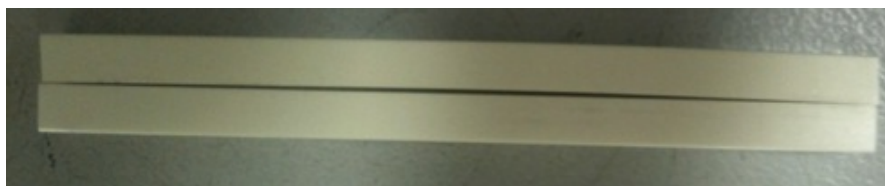
Figure III-23 : Photo d'un échantillon de 11Ce_longlife_D présentant une déformation résiduelle (haut) après interruption de l'essai comparé à un échantillon non testé (bas)
