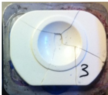
Figure V-40 : Implant LZN130c après test statique
