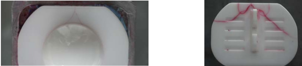
Figure IV-14 : Images d'un implant 3Y-TZP, premier design, après essai statique jusqu'à rupture - face supérieure (gauche) et inférieure (droite) du plateau inférieur de l'implant (partie convexe)
