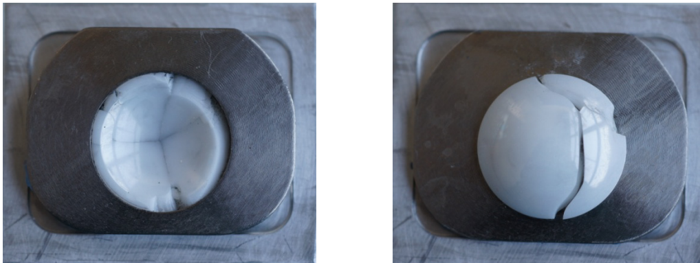
Figure V-16 : Implant TiZ après un million de cycles de fatigue
