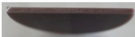
Figure III-40 : Vue en coupe d'un échantillon de 3Y-TZP après stérilisation gamma
