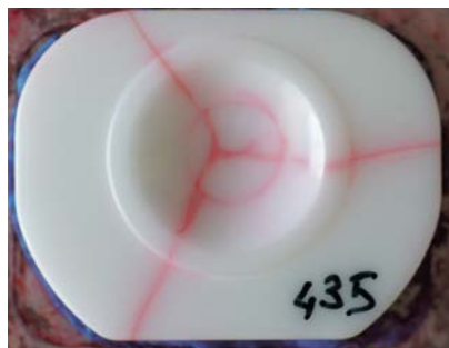
Figure V-38 : Implant YZN435c après test statique - fissures mises en évidence par un pénétrant rouge de ressuage
