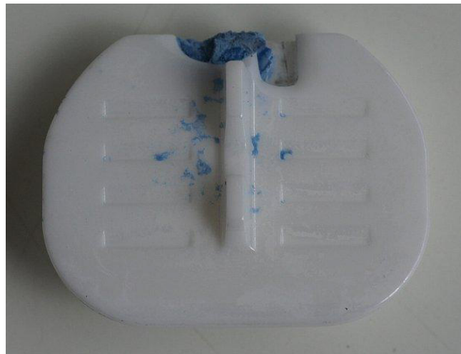
Figure V-32 : Rupture de YZO-40b entre 20 et 30 M de cycles de fatigue cyclique
