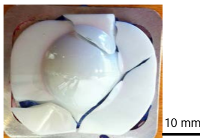
Figure V-36 : Implant YZO25b après test statique
