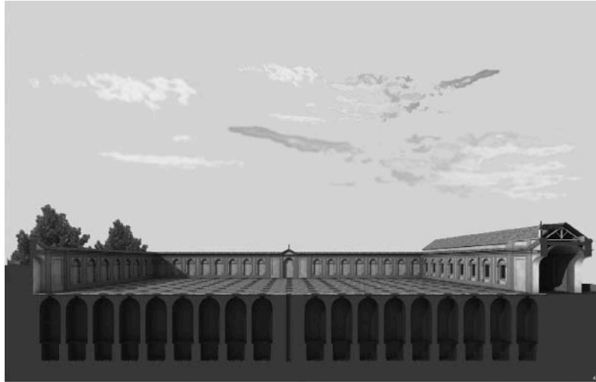
Coupe sur le cimetière des 366 fosses à Naples. source : Latini 53
