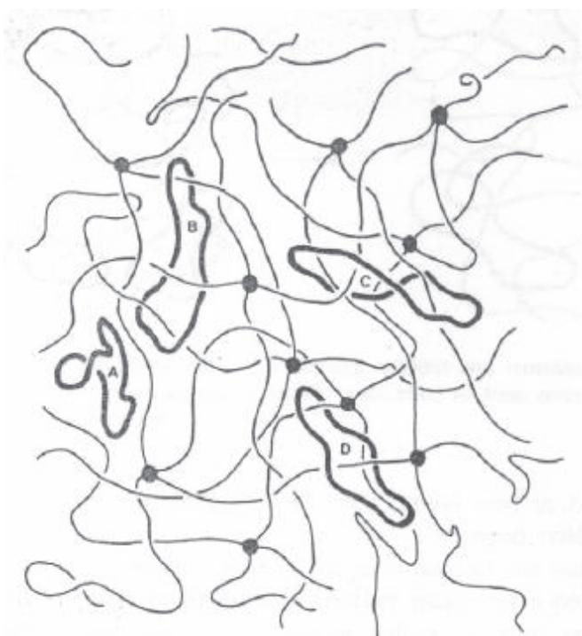
Figure 27 : Schéma de piégeages des oligomères cycliques pendant la formation du réseau (Mark, 1989).
