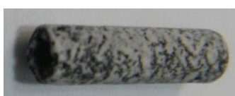
MonoTrap™ RGC18 (Octadécyl C 18 + Carbone graphite)
