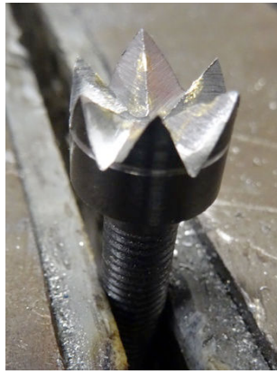
Vue de la fabrication d'un sertisseur en étoile, pour fermer les cartouches feuillette.
