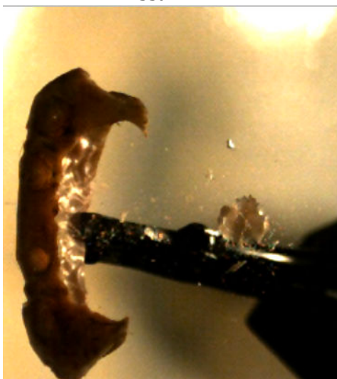
Figure 136 : visualisation des débris générés par l'impact
