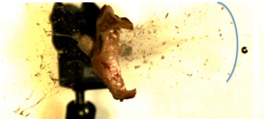
Figure 133 : vue du premier "rideau de débris"
