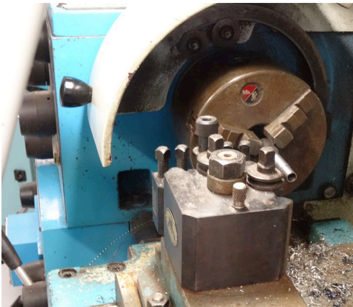
Vue de la fabrication par tournage d'un culot rapporté en acier afin de pouvoir adapter des parties de corps d'étui avec leur épaulement et collet rétreint.
