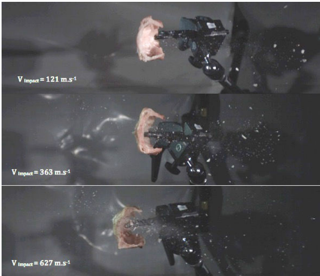
Figure 128 : vue du nuage de débris à différentes vitesses d'impact
