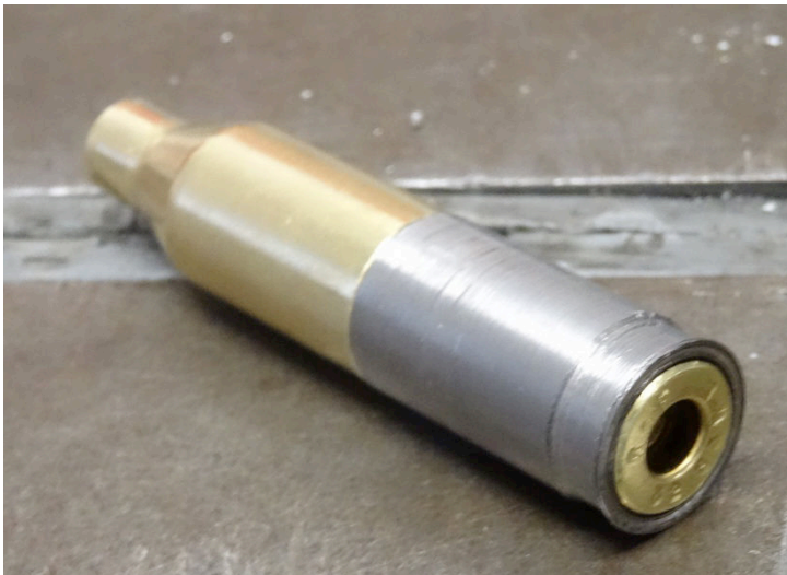
Vue de l'ensemble, le collet retreint sera mis en forme à un diamètre de 5,9 mm (+ou- 0,1 mm)
