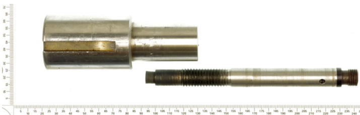
Vue du canon utilisé pour tirer des munitions du type .243 W modifiées pour tirer des billes en acier de 6 mm, avec ou sans fausse cartouche à feuillette.
